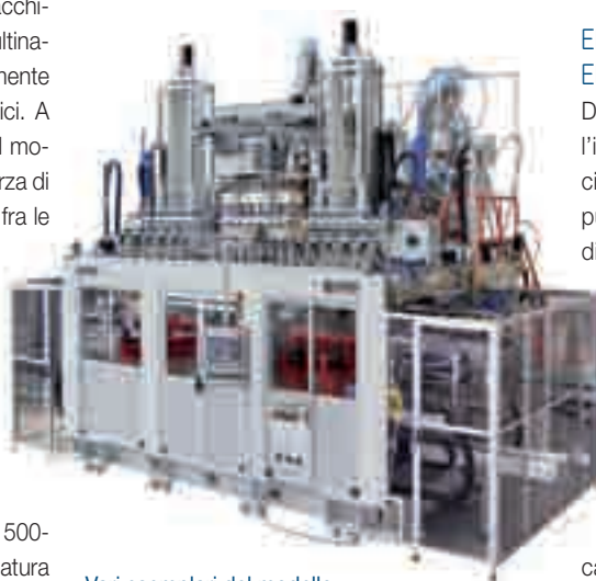
Vari esemplari del modello UMS 500-D, con sistema IML su entrambi i lati, sono in funzione per la produzione di contenitori per olio lubrificante
