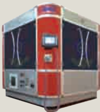
La MHM combina un'unità di stampa serigrafica e una di transfer digitale
