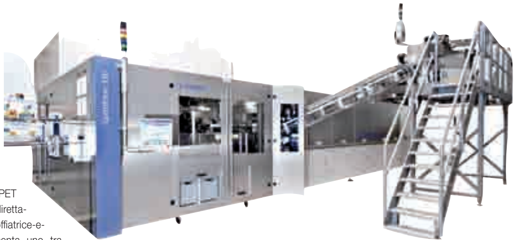
Le soffiatrici Contiform 3 sono una delle tre macchine che compongono il blocco ErgoBloc L per soffiare, etichettare e riempire fino a 81 mila contenitori all'ora
