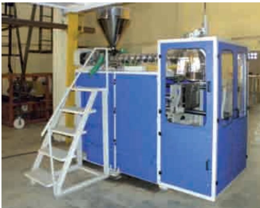
Grazie al dispositivo di autosbavatura e al sistema IML, la soffiatrice sviluppata da Smart Machineries and Moulds riduce le lavorazioni secondarie nella produzione dei contenitori
