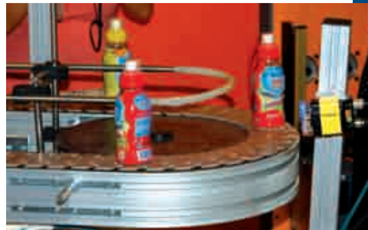
Particolare del sistema di rilevamento della presenza dei tappi e delle etichette integre sulle bottiglie: in evidenza il dispositivo Cognex di visione evoluto
