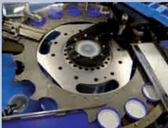
La "lining machine" consente di tagliare i liner e di inserirli in modo preciso all'interno dei tappi a una cadenza fino a 200 pezzi al minuto
