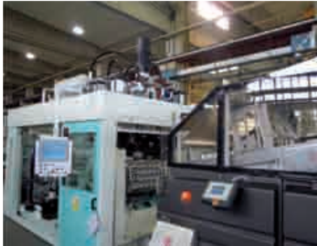
La termoformatrice AMP 630-GP può raggiungere una produttività oraria di 33 mila bicchieri da 500 ml o di 35 mila da 450 ml
