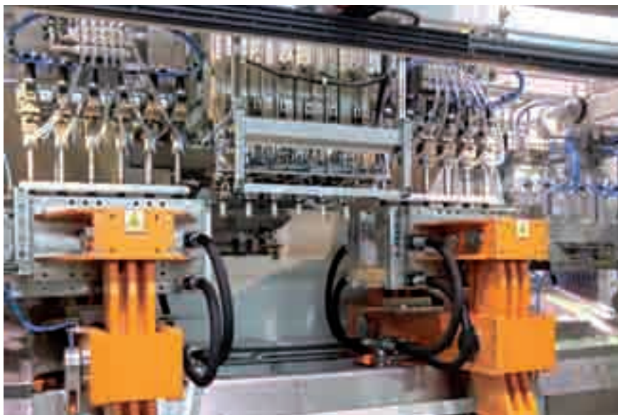
Ciascuna stazione della soffiatrice elettrica PB10E/DXL può ospitare fino a 6 cavità con interasse di 120 mm
