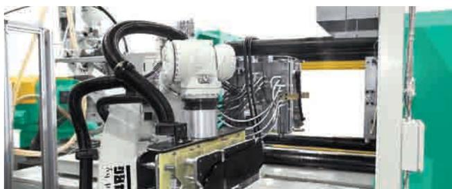
Un robot a sei assi inserisce i laminati organici preriscaldati in uno stampo LIPA (Lightweight Integrated Process Application)
