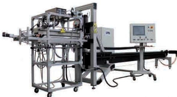
**La macchina per la formatura-curvatura di profili in termoplastico rinforzato con fibre continue, messa a punto dal dipartimento Costruzioni meccaniche dell'Università di Siegen**
