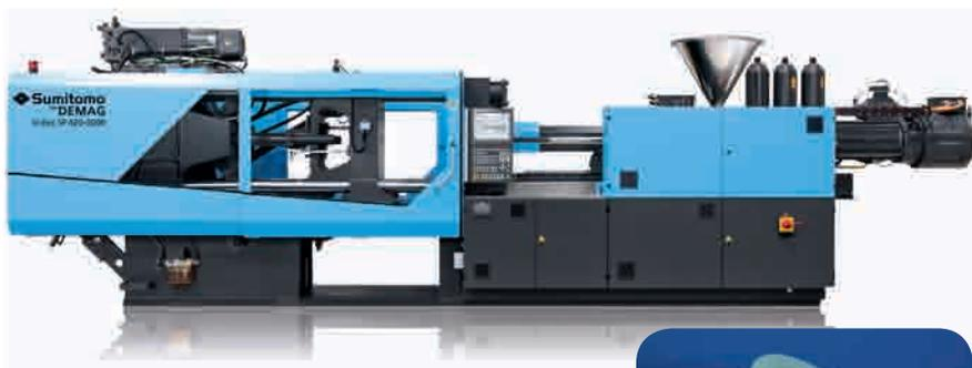
Capsule in HDPE per bottiglie d'acqua minerale, prodotte in condizioni stabili di processo con uno stampo a 96 impronte sulla pressa El-Exis SP 420 in un tempo di ciclo al di sotto dei 2 secondi (foto: Sumitomo (SHI) Demag)
