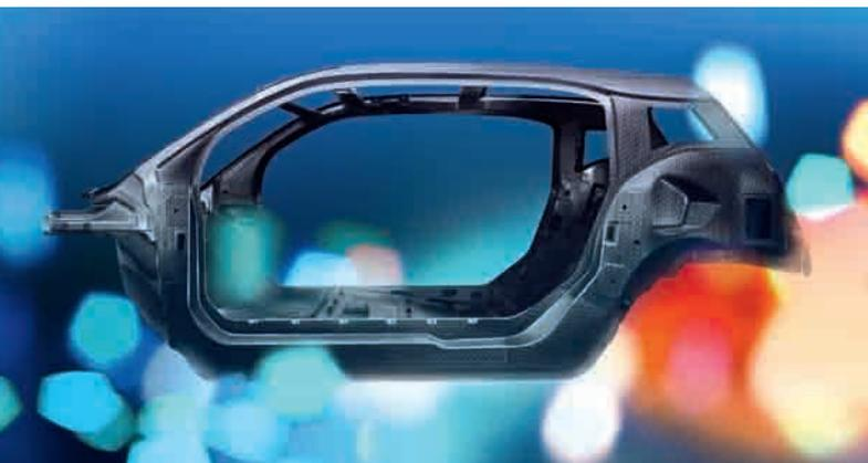
**Il Gruppo BMW è stato premiato per la prima linea al mondo per la fabbricazione industriale di componenti in CRP (resine rinforzate con fibre di carbonio) destinati alle autovetture prodotte in grandi serie. In foto il LifeModule per la BMW i3**
