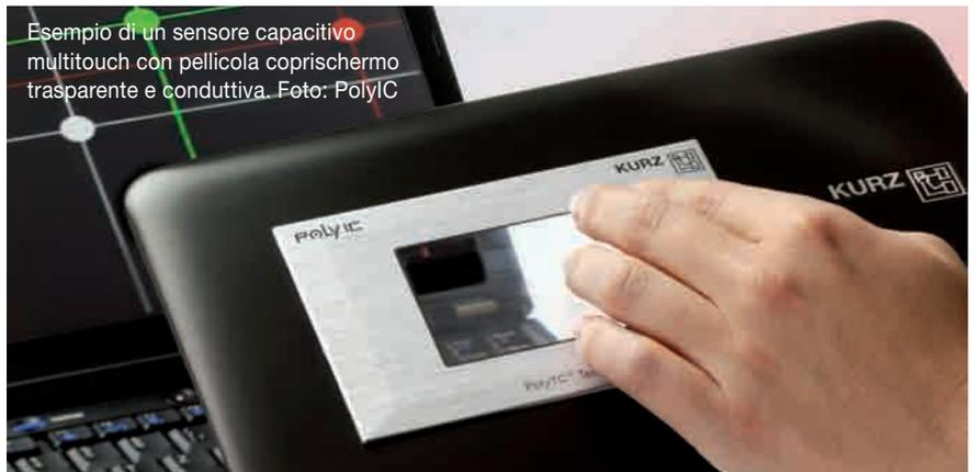
Esempio di un sensore capacitivo multitouch con pellicola coprischermo trasparente e conduttiva. Foto: PolyIC
