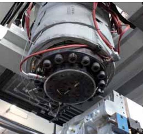
*La testa di accumulo a due cardiodi è dotata di diverter per la stratificazione bilanciata del parison; velocità di estrusione e spessore vengono controllati su 500 punti*
