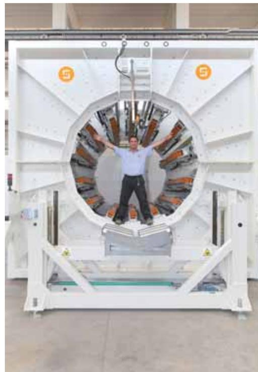
*Uno dei traini multicingolo sviluppati da Sica per tubi in polietilene di elevato diametro e spessore*
