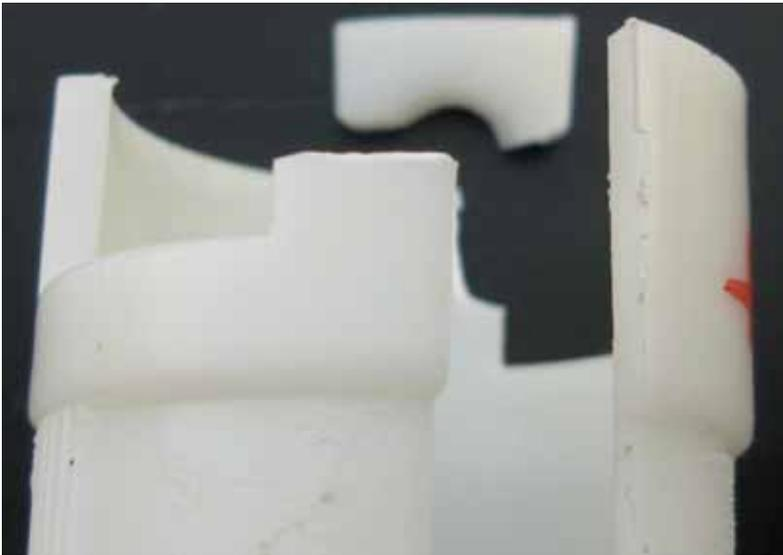
**Figura 2 - Lo stesso manufatto, posto in un ambiente "secco", presentava rotture dopo alcune settimane in esercizio**
