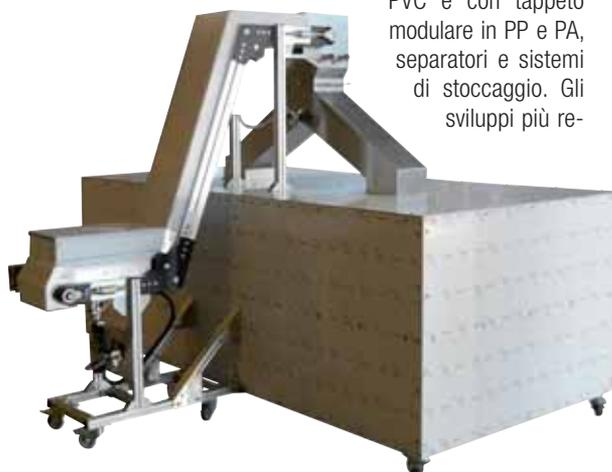
Per l'evacuazione delle materozze sono stati utilizzati nastri trasportatori Crizaf
