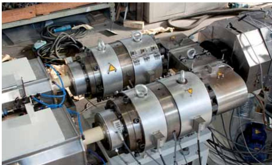
*La testa doppia divide il flusso nel modo più omogeneo possibile, evitando ristagni, punti morti e degradazioni del materiale*
