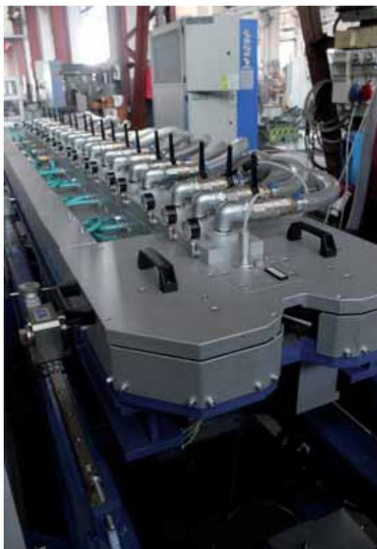
*Sul corrugatore sottovuoto di Olmas si possono installare fino a 120 coppie di semistampi, raggiungendo una lunghezza di 4,5 metri*
