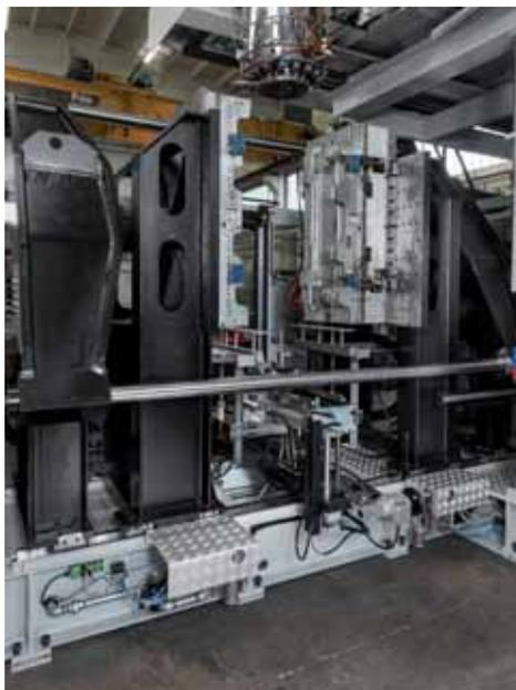
*Il gruppo di chiusura della nuova gamma di soffiatrici Isit è caratterizzato da due colonne in diagonale e tre piastre, due per i semistampi e una per il pistone di azionamento*
