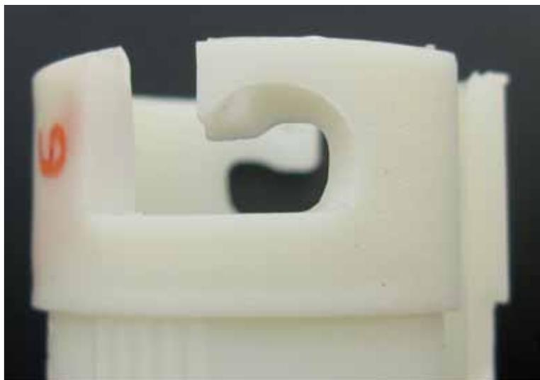
**Figura 1** - Posto in un ambiente "umido", questo pezzo stampato non ha mostrato nessuna riduzione di duttilità ed è rimasto integro
