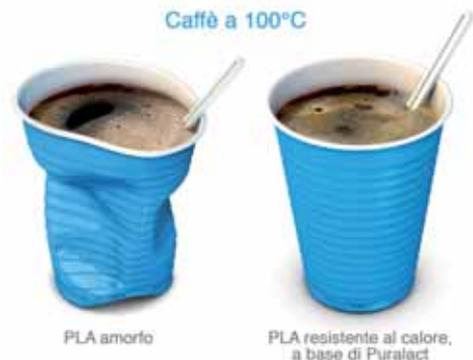
Fig. 1 - I bicchieri in PLA a base di lattidi Puralact sono in grado di contenere acqua bollente senza presentare alcun segno di deformazione
