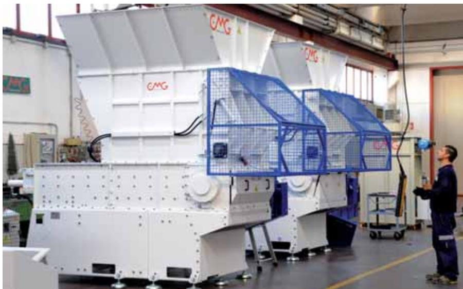
*La serie TRM di trituratori monoalbero è caratterizzata da un sistema di taglio in grado di trattare svariati tipi di scarti e materiali con un'unica configurazione del rotore*
