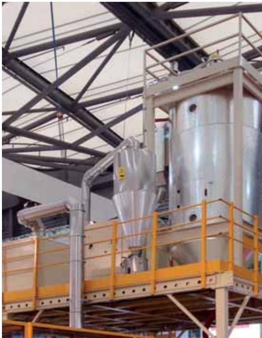
*Dettaglio di un sistema di alimentazione per PET sviluppato da Plastic Systems*
