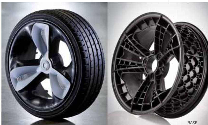
Fig. 2 - La Smart Forvision, presentata nel 2011 al Salone Internazionale dell'Auto di Francoforte, è dotata delle prime ruote al mondo in resina termoplastica che potrebbero essere prodotte in serie. Sono fabbricate in poliammide rinforzata con fibre di vetro lunghe e hanno un peso di 6 kg, pertanto sono più leggere del 30% rispetto alle ruote in alluminio prodotte in serie e riducono il peso complessivo del veicolo di 12 kg
