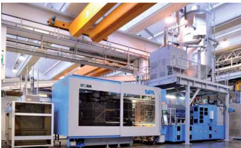
Il sistema XForm messo a punto da Sipa per la produzione di preforme in PET
