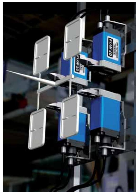
*I tronchesi di Vessel possono essere utilizzati per il taglio delle materozze nello stampaggio a iniezione*
