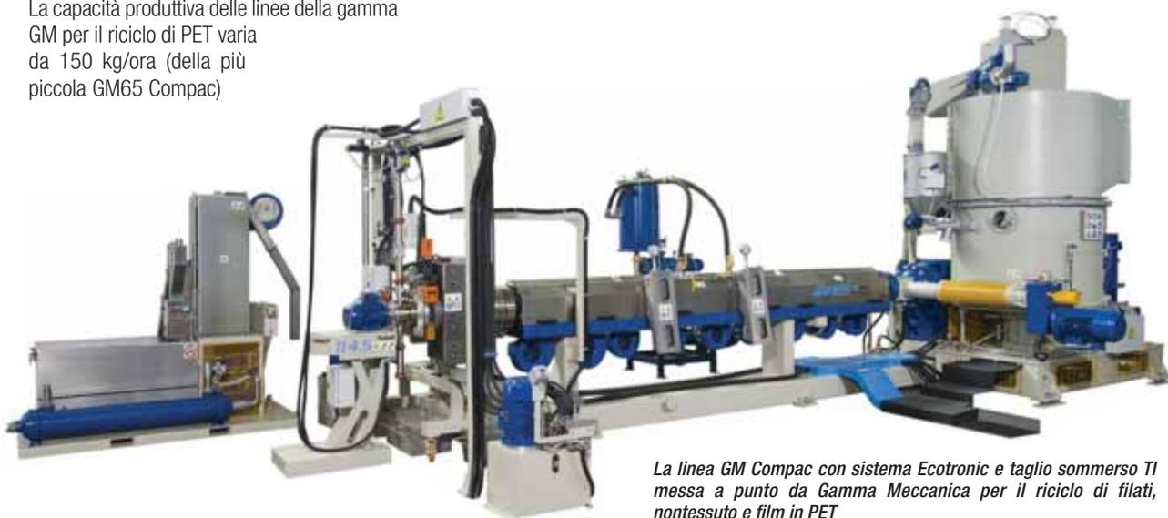
La linea GM Compac con sistema Ecotronic e taglio sommerso TI messa a punto da Gamma Meccanica per il riciclo di filati, nontessuti e film in PET
