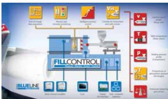
*Schema dei moduli che compongono le serie FillControl e BlueLine per la supervisione e il controllo del processo di stampaggio a iniezione*
