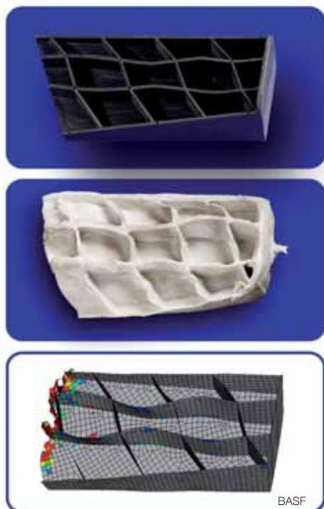
Fig. 3 - Le fibre di vetro lunghe formano un reticolo tridimensionale durante lo stampaggio a iniezione (al centro della figura), il quale conferisce al componente eccezionali prestazioni meccaniche, per esempio nell'uso come ammortizzatore per la carrozzeria. Oggi il comportamento di tali componenti tecnici può essere anche calcolato e previsto mediante simulazioni computerizzate
