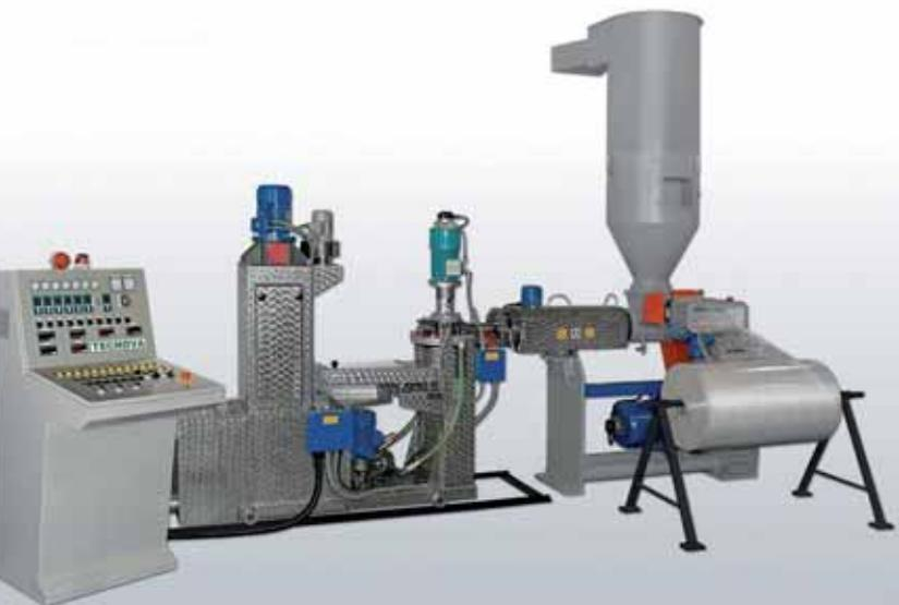
La linea Refil TTC, sviluppata da Tecnova per il recupero in linea o da bobina di rifili di scarto degli impianti per estrusione di film
