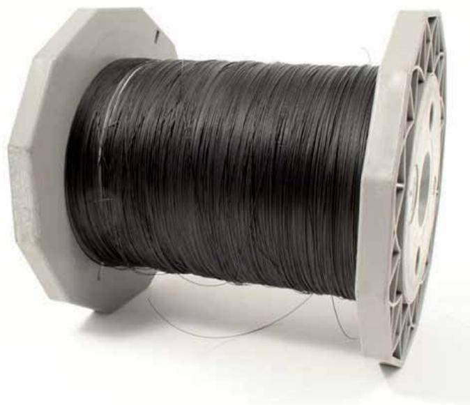
*Il filato elettroconduttivo ottenuto da Lati e Gimac estrudendo un compound di PA12 caricato con nanotubi di carbonio*
