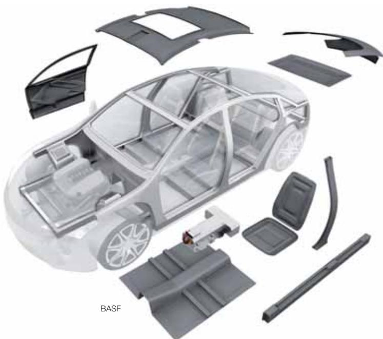
**Fig. 1 - Oggi la più grande sfida per le strutture leggere con polimeri rinforzati con fibre è lo sviluppo di tecniche di produzione in serie, rapide ed economiche, per componenti di grandi dimensioni quali: portiere, tettucci o portelloni posteriori, nonché per componenti strutturali quali: montanti B, soglie o sottoscocche con le necessarie prestazioni meccaniche**
