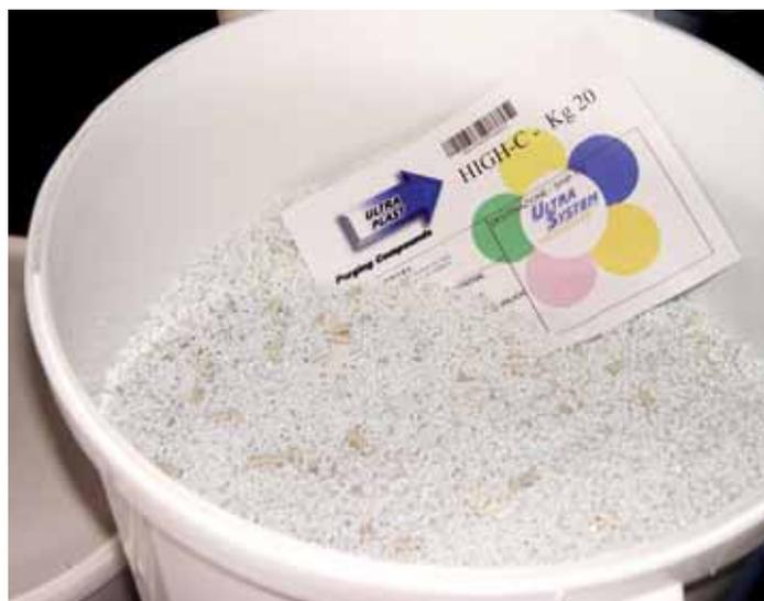
*Durante i cambi di materiale o di colore il compound Ultra Plast High-C garantisce, dopo breve tempo, pezzi chiari e brillanti nella produzione di visiere, lenti, fanali auto e plafoniere*
