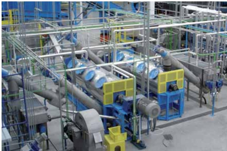
*Durante la permanenza del prodotto nel tamburo, l'azione dell'attrito generato dal rotore, unita a quella dell'acqua calda e dei prodotti chimici, permette il perfetto lavaggio delle scaglie di PET*
