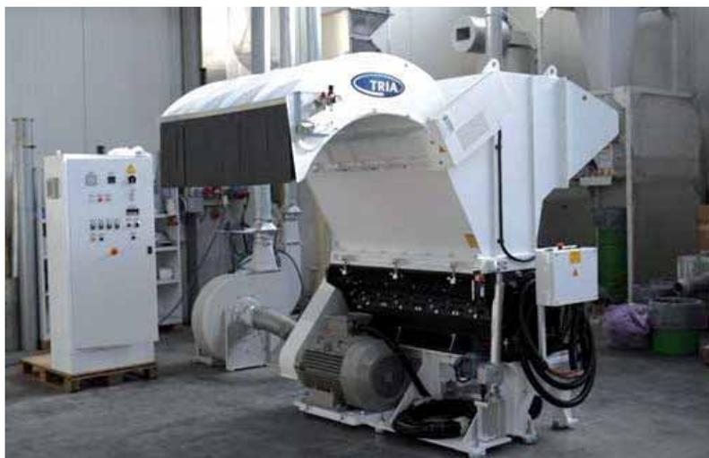
*Il granulatore 120-42 TR è dotato di doppia alimentazione per scarti in bobina con vaschette da 120 mm di profondità e per lastra piena*
