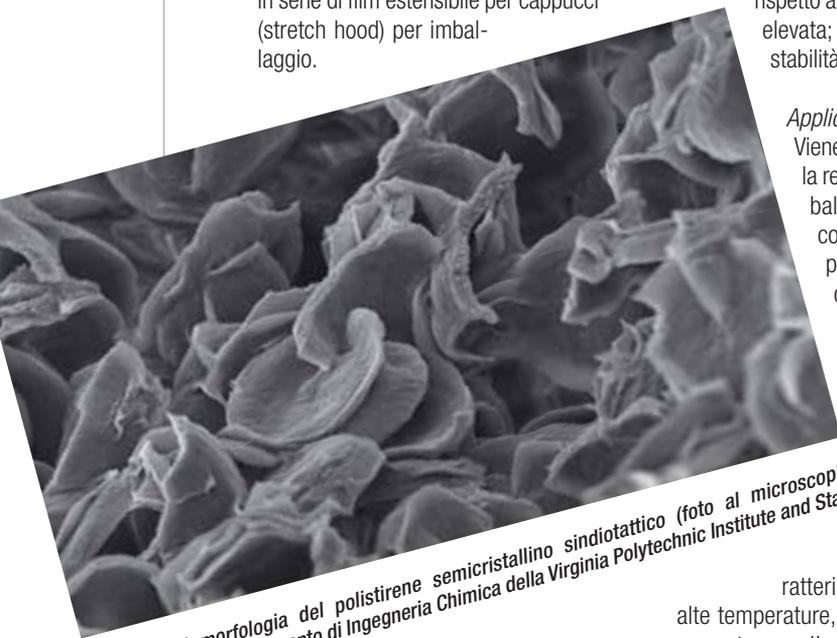
Esempio di morfologia del polistirene semicristallino sindiotattico (foto al microscopio elettronico del Dipartimento di Ingegneria Chimica della Virginia Polytechnic Institute and State University)
