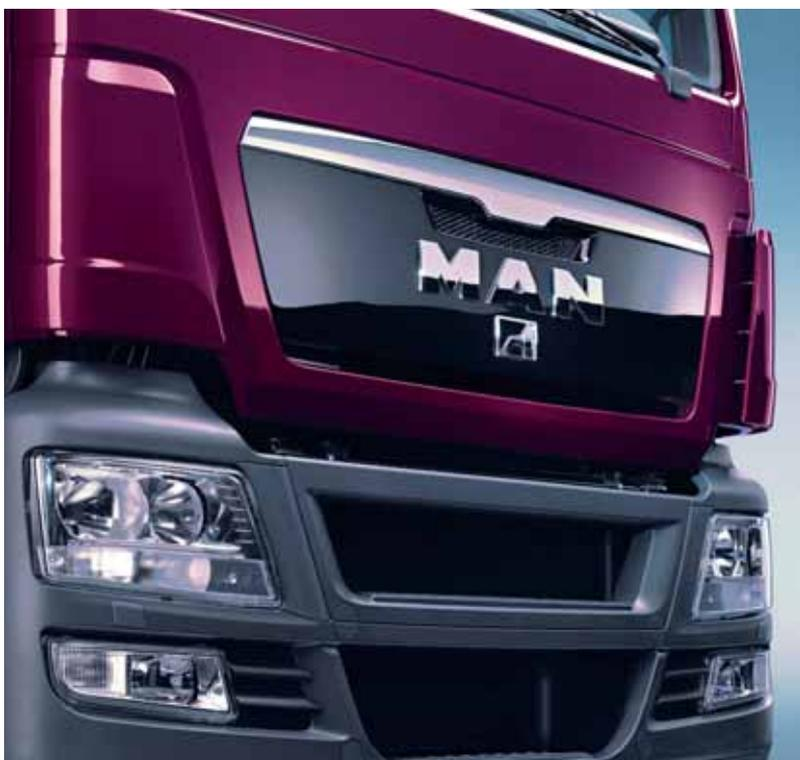
Fig. 4 - Il poliuretano rinforzato con fibre lunghe viene già utilizzato nelle griglie del radiatore degli autocarri MAN (foto: MAN)
