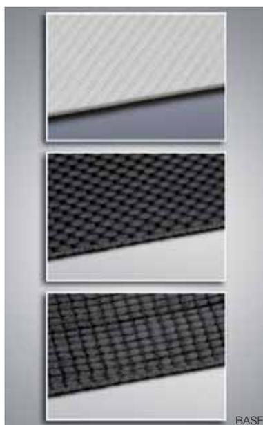
Fig. 9b - Tre laminati RTM in composito realizzati in PA, PUR e resina epossidica
