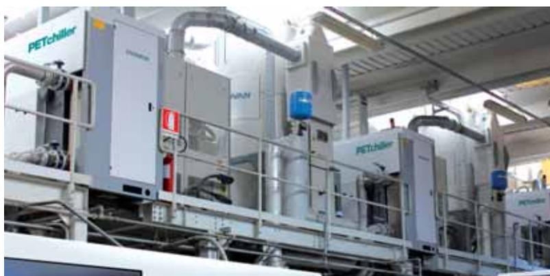
Una batteria di refrigeratori ad alta efficienza PETChiller, sviluppati da Piovan specificamente per la lavorazione del PET, installata presso Puccetti Materie Plastiche
