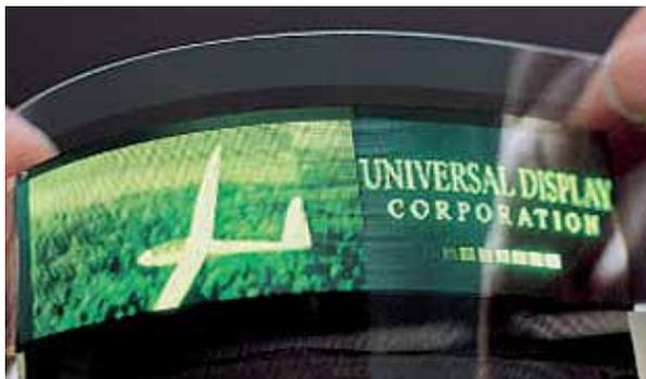
*Senza le materie plastiche la realizzazione di schermi ultrapiatti flessibili per televisori mediante l'uso di OLED (Organic Light-Emitting Diode) non sarebbe stata possibile*
