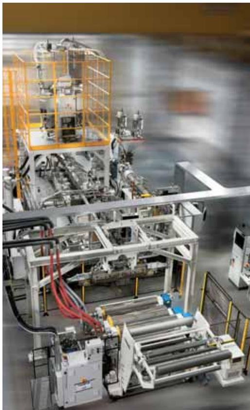
Un impianto completo sviluppato da Bandera per la coestruzione di lastre in PET
