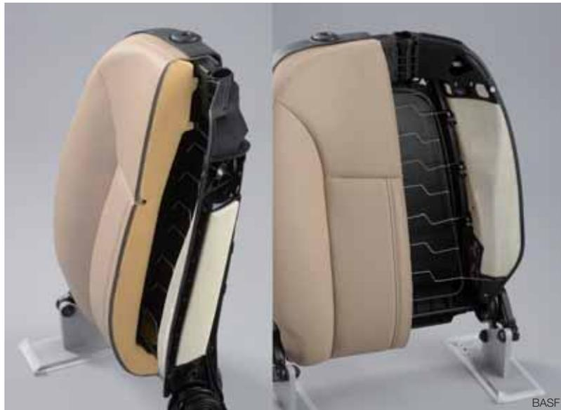
Fig. 6 - Il prototipo di sedile Susco 1.5 di Faurecia è stato sviluppato congiuntamente con Basf e utilizza filati termoplastici in fibra continua per il retro del sedile (parte bianca nella foto), che in un secondo processo vengono sovrastampati con una poliammide speciale (parti nere del retro del sedile). La sostituzione della struttura esistente in metallo con un componente in materiale plastico (pezzo unico) riduce il peso di circa il 20%
