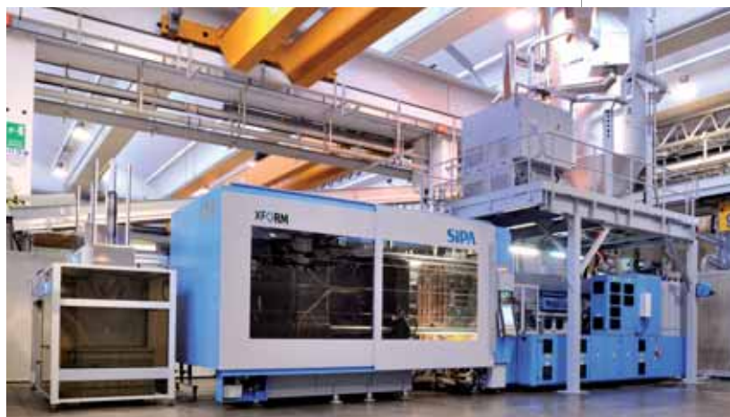
Il sistema XForm messo a punto da Sipa per la produzione di preforme in PET
