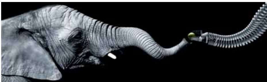
La proboscide degli elefanti ha ispirato il sistema di manipolazione a controllo pneumatico Bionic Handling Assistant
