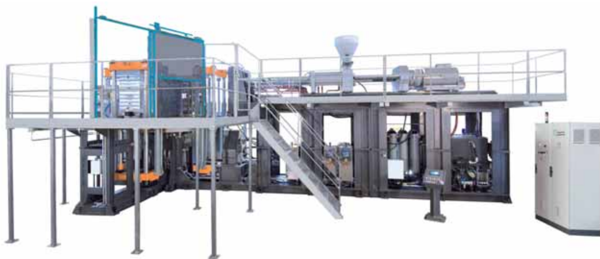
La macchina a iniezione con tavola rotante a quattro stazioni sviluppata da Presma per lo stampaggio di coni segnaletici in PVC
