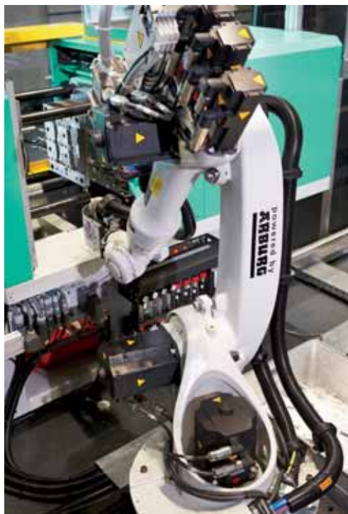
Il robot a sei assi per la manipolazione dei badge prodotti con l'isola per stampaggio e stampa digitale messa a punto da Arburg e FPT Robotik
