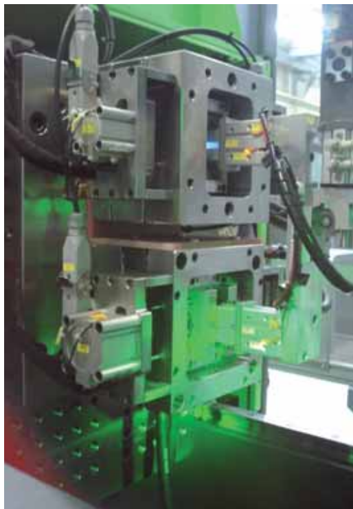
Stampaggio bimeriale su una victory 200/80 tech: nell'impronta in basso viene stampato il corpo della chiusura in termoplastico, che è poi trasferito nell'impronta superiore dove viene iniettato il silicone liquido. In alto si nota l'irradiazione dell'LSR con raggi ultravioletti
