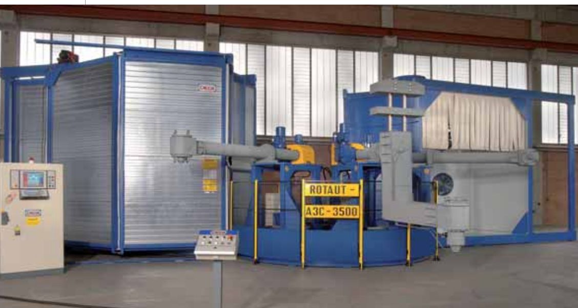
Impianto per stampaggio rotazionale Rotaut A3C - 3500
