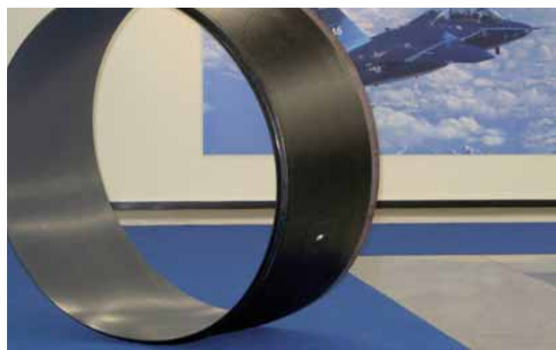
La copertura in materiale composito HexWeb Acousti-Cap consente di ridurre drasticamente il rumore nei motori per aerei durante il decollo e l'atterraggio, senza penalizzare il peso strutturale del velivolo
