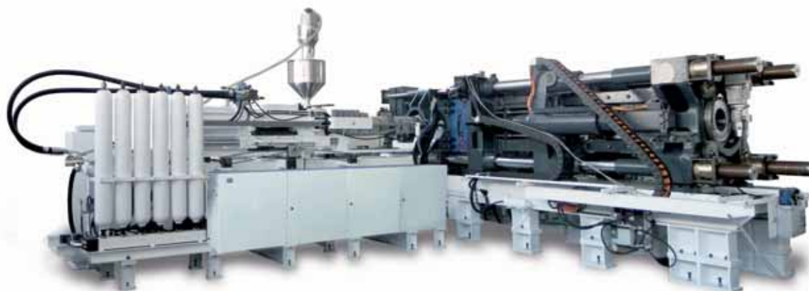
Sulle macchine a iniezione eKW Stack Hybrid l'unità d'iniezione è posizionata ortogonalmente al gruppo di chiusura
