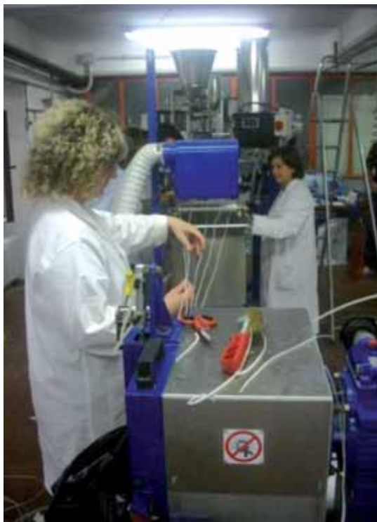
Progetto Forbioplast: compositi in plastica e fibre naturali estrusi con un impianto pilota basato su un estrusore bivate corotante del costruttore italiano Comac
