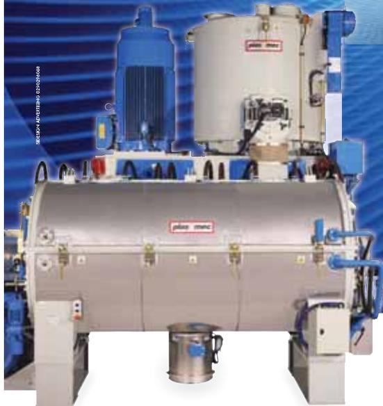
Impianto di miscelazione per PVC con raffreddatore orizzontale ad alta efficienza.
