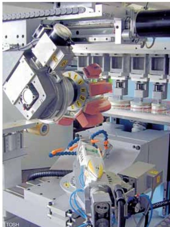
Il modello Cartesio S viene presentato come soluzione in grado di assicurare una flessibilità estremamente elevata. Tutti i movimenti della macchina, da quello dell'articolo da stampare a quello del tamburo porta-tamponi, dispongono di controllo numerico su più assi, permettendo la decorazione, in un unico ciclo di stampa, anche di articoli con aree non raggiungibili con le macchine tradizionali.
