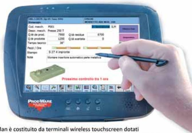
Il sistema i-Man è costituito da terminali wireless touchscreen dotati di un software web-based, che costituisce il lato client del sistema informatico aziendale, e da schede elettroniche che si interfacciano alle presse per rilevarne lo stato, le quantità prodotte ed altri dati.
