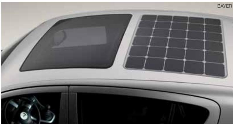
con il tettuccio abbassato un'esperienza incomparabile. Per offrire a chi guida una visuale esterna senza alcun ostacolo anche con il tettuccio alzato, questo sistema modulare viene venduto con l'opzione di un elemento panoramico trasparente prodotto da Webasto mediante un processo di stampaggio a iniezione-compressione bicomponente.
