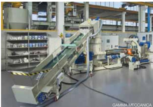
il materiale direttamente nell'estrusore) e dispositivo di taglio immerso, in sostituzione di quello in testa, particolarmente indicato per la rigenerazione di PET, PA e di tutti i materiali molto fluidi.
