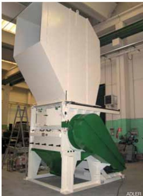
stante la temperatura del materiale senza l'impiego di acqua così da ridurre i consumi energetici nell'ordine del 40% e riciclare materiali con umidità fino al 15%. Il sistema di alimentazione è predisposto per essere attrezzato con dosatori per polveri, master e macinati.
