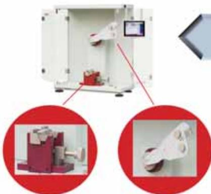
Per prove Charpy ed Izod senza dover cambiare la configurazione del pendolo
