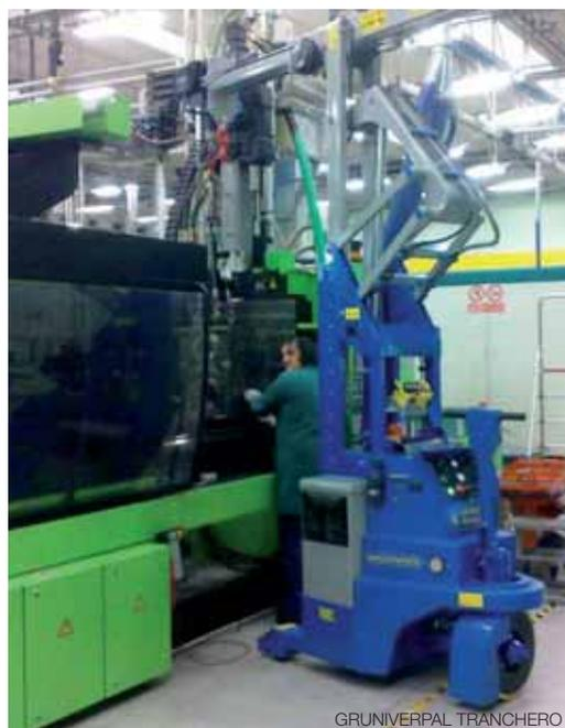
La seconda serie (portata fino a 25 ton) è equipaggiata con radiocomando wireless a movimenti proporzionali. In questo caso l'esperienza acquisita nel settore aeronautico ha consentito di trasferire una serie di know-how nel settore dello stampaggio a iniezione, riuscendo così a eliminare le oscillazioni durante la movimentazione degli stampi grazie a un nuovo sistema
