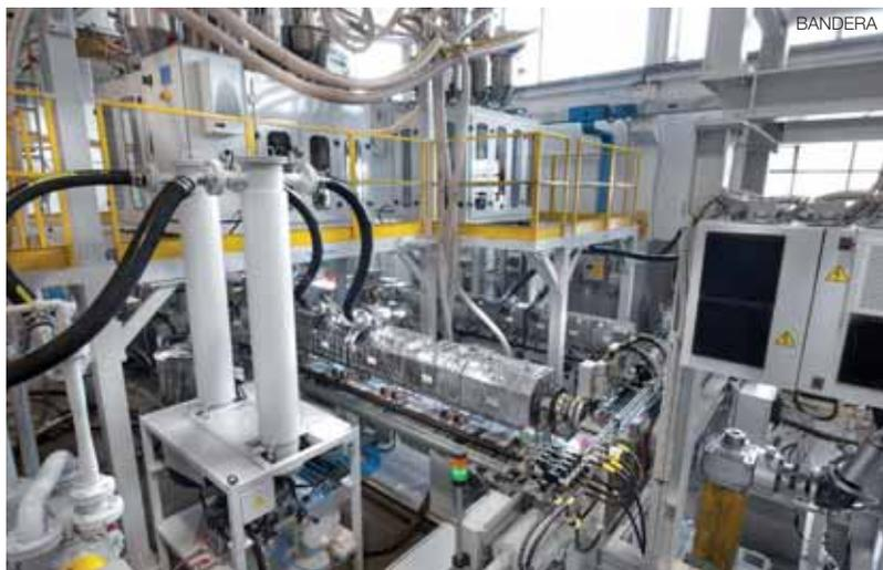
tura con cross-axis, sistema di laminazione per la nobilitazione dell'estruso e avvolgitore automatico di ultima generazione. Le foglie prodotte hanno spessore da 120 (PET) a 1.600 micron e larghezza fino a 1.420.
