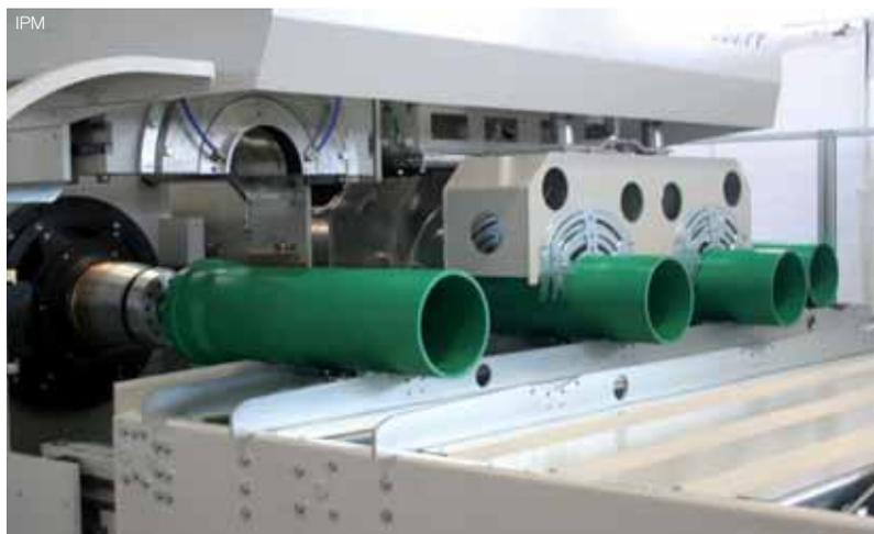
pacità produttiva di queste bicchieratrici (fino a 924 bicchieri/ora per diametro 50 x 1,8 mm) si rende sempre più necessaria la gestione del fine linea, ossia la raccolta, l'imballaggio automatico e il trasporto a magazzino di un numero elevato di tubi. Per tubi prodotti e imballati in modo completa-
