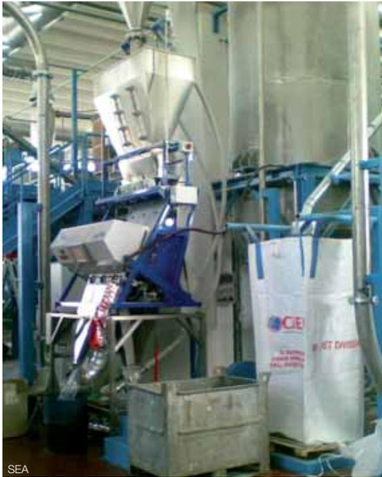
Elevate rese e capacità produttive consentono di ottenere un prodotto finito di qualità elevata. La gamma Pixel trova applicazione pratica presso impianti di riciclo di PVC da profili per finestre, PET da bottiglie post-consumo e HDPE da flaconi, nonché nel recupero di scarti di produzione in vari materiali.
