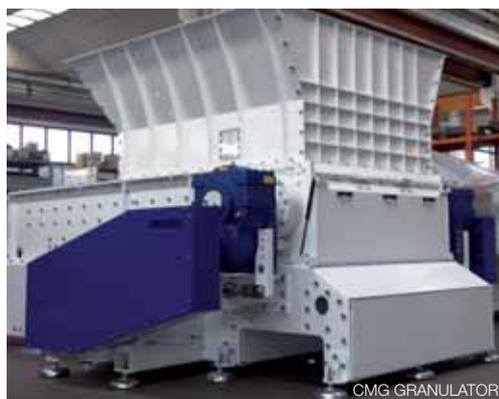
di trattare, con un'unica configurazione del rotore, vari tipi di scarti, accrescendo la flessibilità applicativa della macchina.
