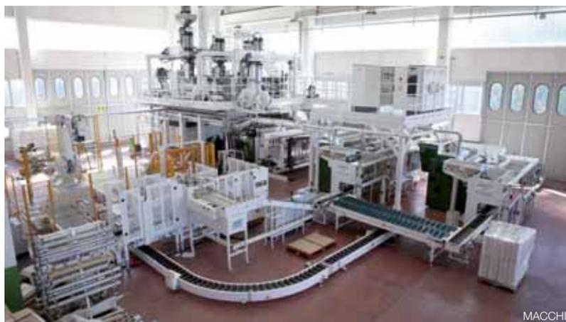
realizzare tubi con diametro da 300 a 1.200 mm prevalentemente a doppia parete per drenaggio e reti fognarie. Così come il modello più piccolo F700 da cui deriva, anche questo utilizza un sistema di movimentazione degli stampi a navetta grazie al quale, mentre quelli della zona di formatura e raffreddamento si muovono alla velocità di produzione, quelli in apertura, chiusura e ritorno si muovono a velocità rispettivamente doppia e quadrupla, per con-
