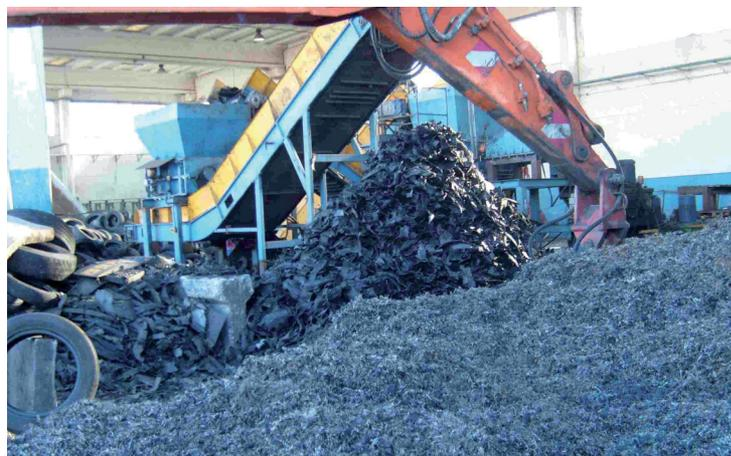
Il granulo di gomma, per le sue proprietà elastiche, viene utilizzato per produrre pannelli insonorizzanti, tappetini anti-calpestio e membrane impermeabilizzanti. Il polverino di gomma viene impiegato per la produzione di asfalti modificati con migliorata resistenza alla fessurazione e conferisce alle pavimentazioni proprietà fonoassorbenti, migliorando la presa dello pneumatico e riducendo gli spazi di frenata.
