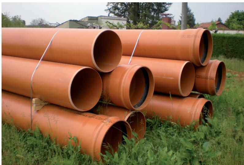
solitamente estruso in applicazioni simili a quella di origine, sia in miscela al 10% unita a PVC vergine in tubazioni per fognature sia al 100% come strato interno in tubazioni a pareti strutturate.
