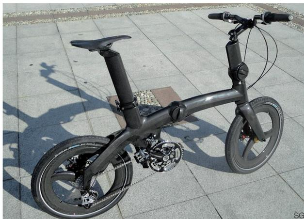
materiale mutuato proprio dalla tecnologia aeronautica e trattato con particolari procedimenti propri del mondo dell'aviazione (trattamento in autoclave a 6 bar di pressione e polimerizzazione a 135°C). Leggerezza assoluta, incredibile resistenza meccanica ed estrema cura nella manifattura (completamente made in Italy) ne fanno un prodotto esclusivo, che realizza prestazioni elevate e ampio campo di utilizzazione.
