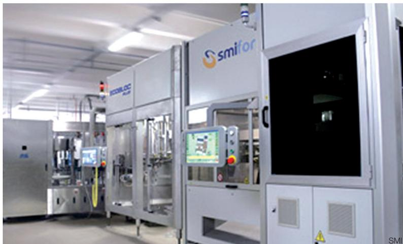
china le funzioni di stiro-soffiaggio, riempimento-tappatura ed etichettatura, garantendo risparmi in termini di investimento iniziale, costi di manutenzione e consumi energetici. Il secondo blocco (Pack Bloc) si basa su un sistema di confezionamento con film termoretraibile che integra l'uscita dal tunnel della fardellatrice con il sistema di palletizzazione.
