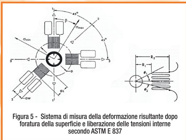
Figura 5 - Sistema di misura della deformazione risultante dopo foratura della superficie e liberazione delle tensioni interne secondo ASTM E 837
