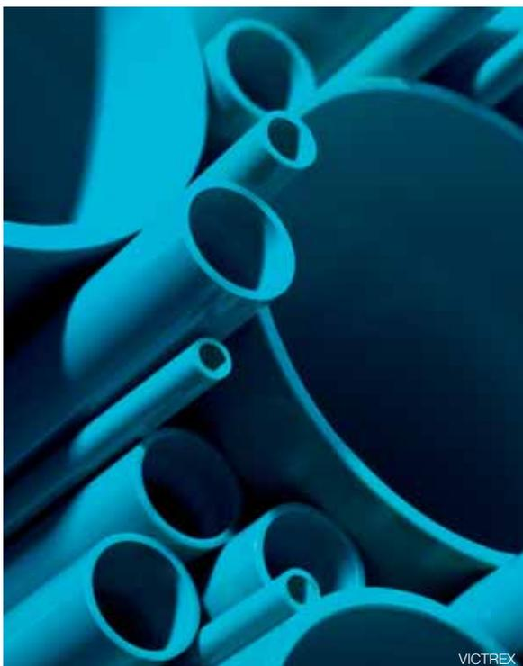
nelle industrie petrolifere e del gas. I prodotti della serie Victrex Pipes sono attualmente disponibili in una gamma di diametri esterni compresi fra 6 e 200 mm, con spessore di parete da 0,8 fino a 5 mm. Sono altresì disponibili in svariate lunghezze o, su diametro inferiore, anche in bobina con lunghezza totale fino a 3.000 m. Le proprietà del PEEK consentono di rivestire le tubazioni in metallo fornendo così
