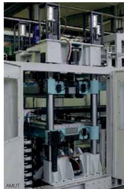
di resistenza e prestazioni a elevate velocità e alti carichi, fondamentali con foglia multistrato in PET come in questo caso. La stazione di formatura dispone di dispositivi per il cambio rapido dello stampo e in dotazione viene fornito un carrello studiato appositamente per facilitarne l'installazione.
