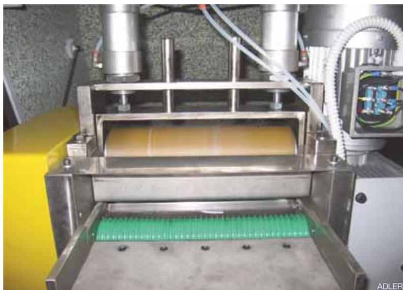
stema di taglio trasversale che garantisce un'esecuzione che non deforma il manufatto e la movimentazione che, secondo la velocità di estrusione e la tolleranza di taglio desiderata, può essere pneumatica o servo-assistita con motore brushless, tradizionale o lineare di nuova concezione a risparmio energetico.
