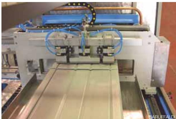
mediante lama commerciale o realizzata su disegno dell'utilizzatore, in linea e non di profili tecnici, per tapparelle e mini canaline. La macchina è concepita per tagliare anche profili estrusi su più uscite e per effettuare tagli multipli.
