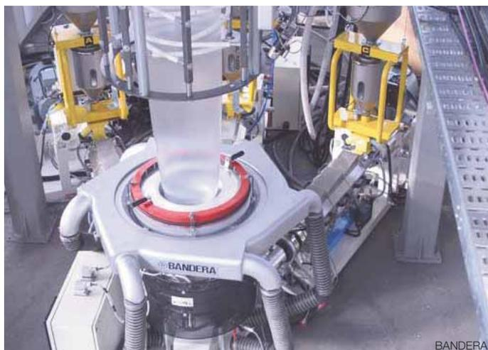
massa fusa. Anche la testa di soffiaggio presenta un nuovo disegno, con canali interni differenziati in funzione delle diverse caratteristiche reologiche del materiale, così come di nuova concezione risulta anche il labbro di uscita per evitare la formazione di eventuali depositi.
