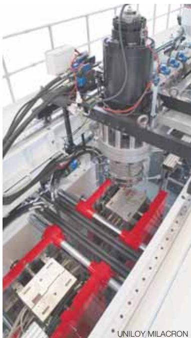
mente la testa di accumulo, mentre la movimentazione affidata al servomotore elettrico programmabile, dotato di sistema di recupero dell'energia generata durante la frenata, consente di posizionare la testa con estrema precisione e di ridurre i consumi.
