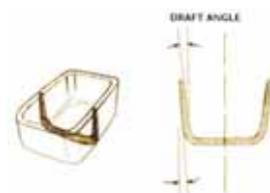
Figura 9 - Schema dell'angolo di sfornatura (draft angle) lato punzone che facilita il distacco del manufatto dallo stampo
