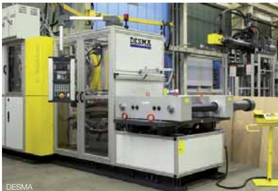
1.010 bar e funziona secondo il principio FIFO (First in First Out). Diversamente da quanto avviene sulle macchine tradizionali, lo statore non viene disposto lungo l'asse longitudinale del gruppo d'iniezione bensì verticalmente con un'inclinazione fino a 90°. Oltre al minore ingombro dell'intero impianto, con questa configurazione il sistema di alimentazione e scarico risulta semplificato grazie al dispositivo di chiusura integrato.
