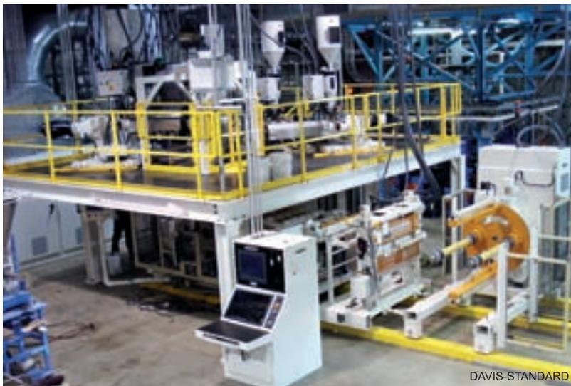
installati e prestazioni migliorate. La nuova unità è basata sulla capacità di adattamento automatico al raffreddamento interno della bolla e al controllo della larghezza.
