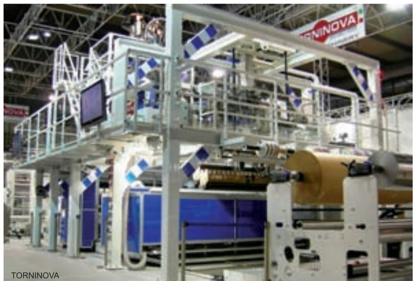
stente assicurando una maggiore capacità protettiva del film rispetto a quelli monostrato di grammatura maggiore. La resistenza di questo film coestruso da 35 g/m<sup>2</sup> è paragonabile a quella di un film monostrato da 55 g/m<sup>2</sup> ma con un risparmio superiore al 30% in termini di materie prime.
