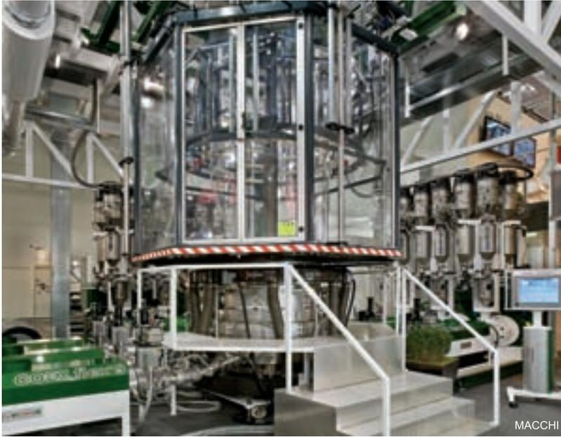
mario dopo l'estrusione sia nuovamente riscaldato e orientato sia nel senso di avanzamento sia trasversalmente.
