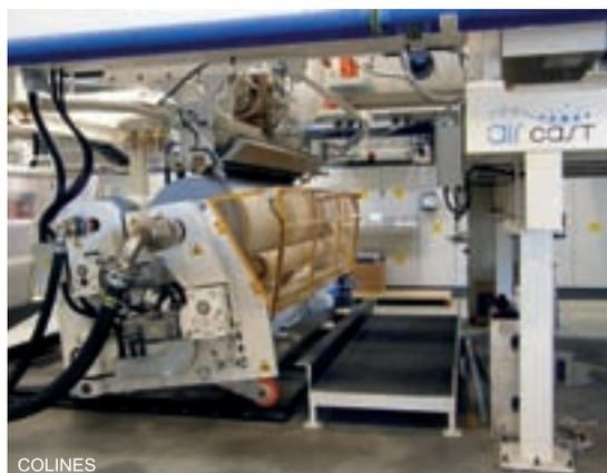
metri e finiture differenti. Il profilo del film viene monitorato mediante un sistema a raggi beta. L'avvolgitore, che opera con tecnologia sia "gap" sia a contatto secondo il tipo di produzione, comprende una stazione di taglio in linea per ottenere fino a 7 bobine indipendenti e un sistema robotizzato per la manipolazione degli aspi.
