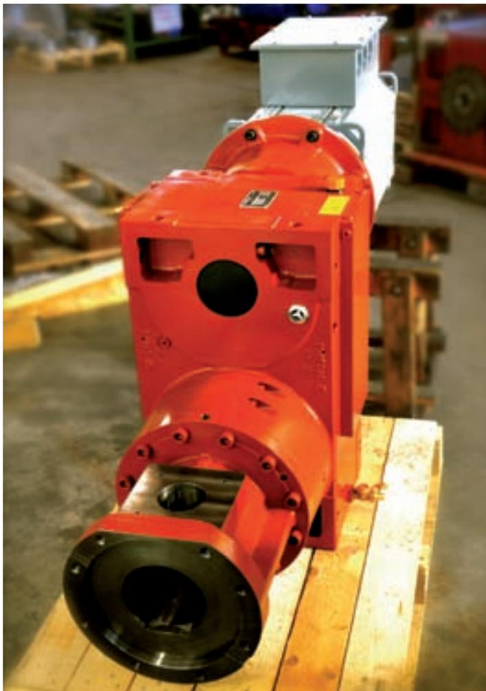
Motoriduttore con bocca di alimentazione per estrusore monovite
