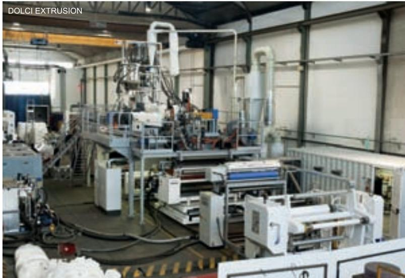
traspirabilità al film dopo la fase di doppio stiro. Una volta passato attraverso il chill-roll per il raffreddamento costante e uniforme, il film può essere eventualmente goffrato per adattarsi a svariate esigenze applicative.
