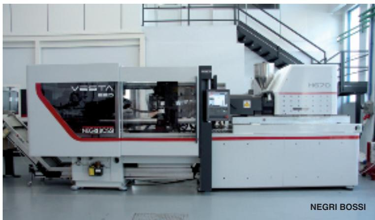
rumorosità. La cella di carico per il rilievo delle pressioni, posta nel gruppo iniezione in posizione baricentrica, consente una misura estremamente precisa delle pressioni in gioco - a tutto vantaggio del
