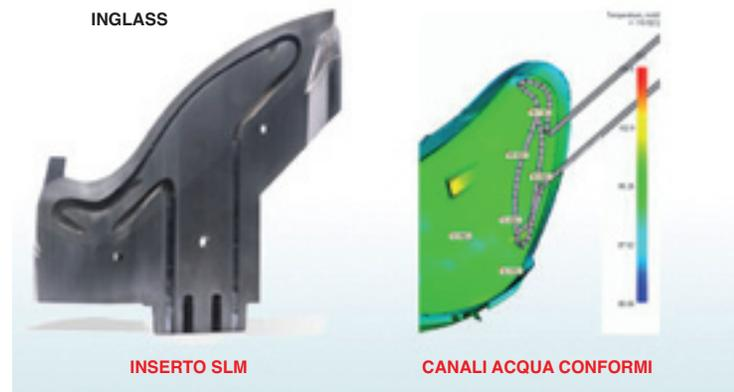
correlate anche a un corretto riempimento delle impronte. A tal proposito Inglass offre, in primo luogo, un'analisi del riempimento e del sistema di condizionamento e, in secondo luogo, propone una soluzione per ottimizzare ogni sistema di condizionamento richiesto, incluso il giusto posizionamento.
