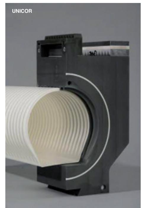
d'acqua - sono realizzati per lo più in PVC, ma anche in PE e PP, dato che i materiali plastici offrono una elevata rigidità anulare. Il fondo piatto del tubo a contatto con il suolo rende il drenaggio molto più efficiente di quello di un tubo corrugato a sezione circolare.
