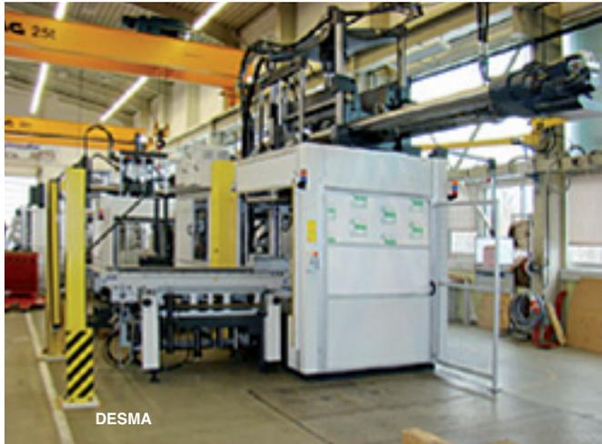
di componenti di grandi dimensioni. Ciò è reso possibile anche dal dislocamento sulla stazione esterna delle procedure di alimentazione e distacco dallo stampo così come delle operazioni di pulizia, mentre nell'unità di chiusura è in corso la vulcanizzazione.
