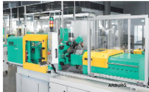
L'alimentazione di un fuso omogeneo è un pre-requisito per realizzare componenti di elevata qualità costante. A questo scopo la pressione nel punto di trasferimento tra la vite di pre-plastificazione e quella d'iniezione viene monitorata e regolata ed eventuali scostamenti della pressione reale dai valori nominali sono compensati con la regolazione della velocità di rotazione della vite.
