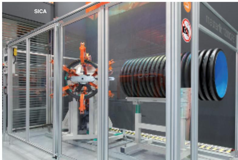
a poter essere posizionata sul tubo. A questo punto un dispositivo di alimentazione motorizzato a nastro che supporta il tubo corrugato muove quest'ultimo verso la macchina, in modo che la sua estremità raggiunga un apposito piano di riscontro, mentre una fotocellula ne rileva l'effettiva presenza. Quando
