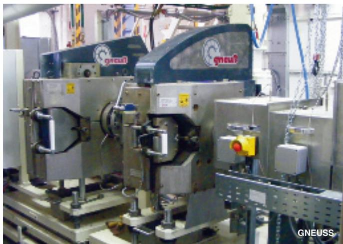
finezza nell'ordine di 500 micron. La combinazione dei due filtri risulta funzionale al fatto che l'estrusore non riesce a generare una pressione sufficientemente elevata per eseguire il necessario filtraggio fine di 40 micron. Tale compito è invece affidato a una pompa del fuso installata tra i due filtri. Il secondo di questi (quello principale, RSFgenius 175) è dotato di un dispositivo di risciacquo per la pulizia automatica del filtro stesso. Entrambi i filtri sono muniti di piastra di
