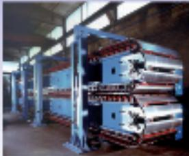
**Doppio nastro trasportatore per la produzione in continuo di pannelli sandwich isolanti**
