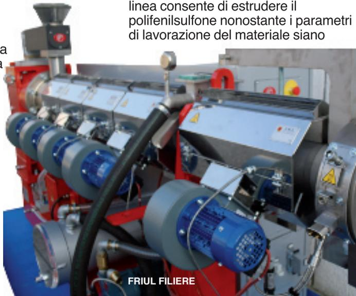
estremi: per esempio, la temperatura è compresa tra 350 e 400°C e il punto di rammollimento Vicat si attesta a 230°C; il polimero, inoltre, allo stato di plastificazione ha una fluidità molto elevata e, quindi, complessa da gestire.
