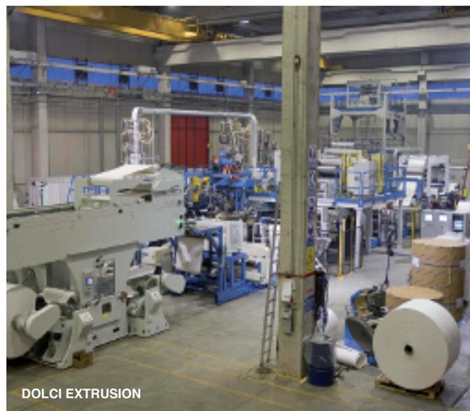
produce mattonelle di film pressato da rivendere ai riciclatori. Dopo il secondo stadio, uno scanner a raggi beta e infrarossi rileva lo spessore totale e quello delle resine sul lato libero dell'alluminio e controlla la seconda testa. Dopo il terzo stadio, infine, un altro scanner beta rileva lo spessore totale e controlla il profilo della terza testa.
