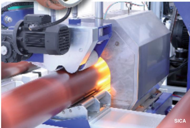
acqua, per convezione tramite flussi di aria compressa pre-raffreddata che lambiscono l'interno del bicchiere nella prima fase di formatura e l'esterno nella seconda.
