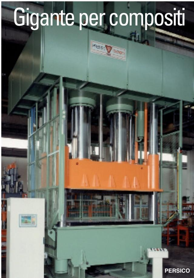
mici, assicura una maggior uniformità nei tempi e nelle velocità dei movimenti della pressa. Anche a motori spenti, durante la fase di pressata, la pompa del circuito filtraggio raffreddamento continua a lavorare sopra i 40°C. Sempre al fine di garantire costanza e ripetibilità di movimenti, tempi e pressioni, l'impianto oleodinamico è di tipo in anello chiuso.
