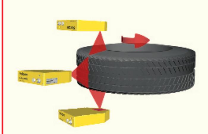
FIGURA 2 - SISTEMA PER ISPEZIONE FINALE DELLO PNEUMATICO
