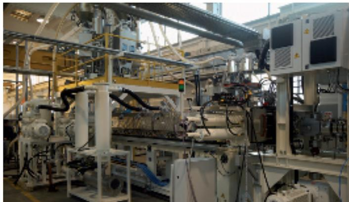
di purificazione, impiegato per ottenere lo strato interno ottenuto con materiale prettamente rigenerato, e 32 estrusori monovite TR (L/D = 35) con degasaggio, per realizzare gli strati esterni in materiale vergine.
