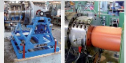
Teste d'estrusione di nuovo design per tubi in HDPE e PVC (anche con materiale espanso per tubi a tre strati)
