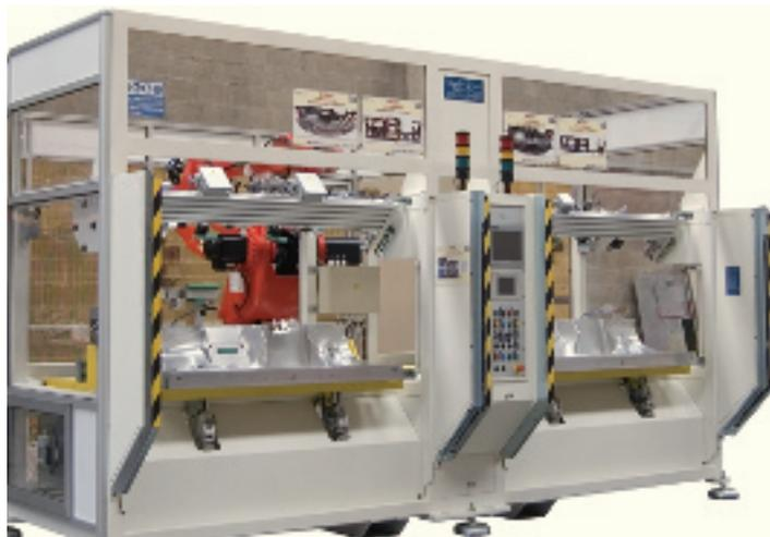
Nella prima stazione sono saldati quasi tutti i particolari, fatta eccezione per la canalizzazione. Nella seconda è saldata la canalizzazione di sbrinamento che copre i diffusori d'aria, saldati in precedenza, assieme a dei rinforzi. Inoltre è ultimata la saldatura dei punti che non è stato possibile saldare in precedenza.
