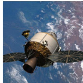
Exploration Vehicle) Orion. Il nuovo velivolo spaziale, che ricorda molto le vecchie capsule Apollo degli anni Sessanta, è composto da due parti principali: la capsula conica, che ospita l'equipaggio, e un modulo di servizio contenente tutte le attrezzature per la propulsione, i sistemi
