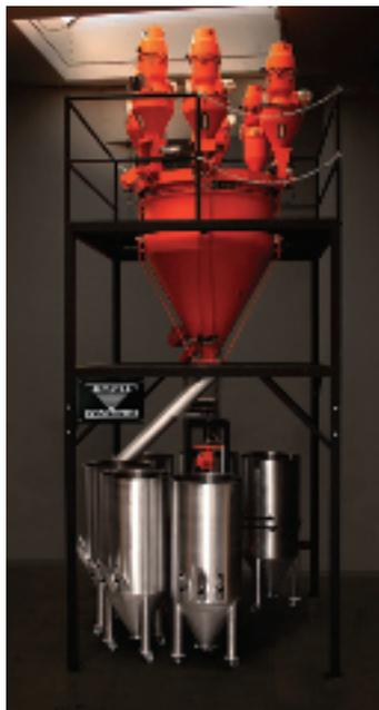
gravimetrici Opti-Mix, equipaggiata con la funzione Auto-Clean, è stata sviluppata da TSM Control Systems per permettere ai trasformatori di ridurre il consumo di materiale vergine grazie a una più precisa miscelazione e utilizzare una maggiore quantità di rimacinato senza costi aggiuntivi né compromettere la qualità del prodotto finale.
