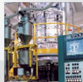
Impianto completo di coestrusione a 5 strati per la produzione di film barriera per imballaggio
