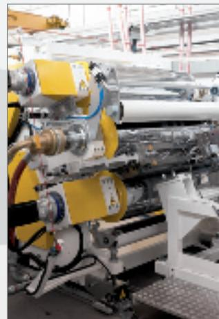
Calandra di linea completa per l'estrusione di foglie sottili per il settore del packaging termoformato rigido (PET, PS, PLA, PP)
