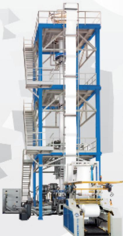
Impianto di coestrusione a 3 strati per la produzione di Sacchi Industriali (HDB) di ultima generazione, con capacità produttiva di oltre 320 Kg/h
