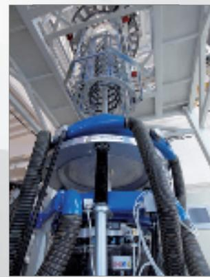
Impianto completo di coestrusione a 5 strati per la produzione di film barriera per imballaggio
