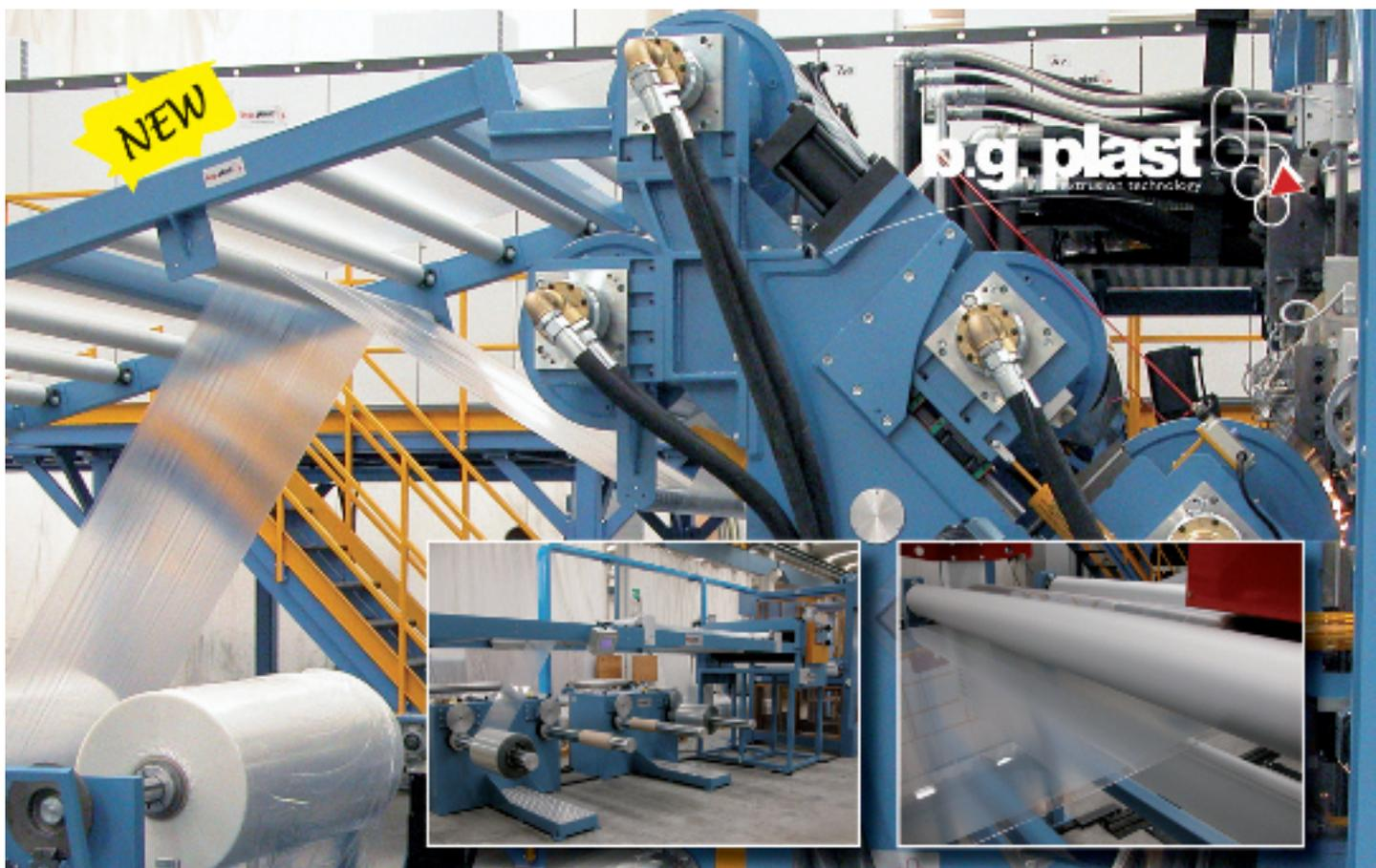
Linea di coestrusione PET (A-B-A) da 1500 kg/ora a partire da 100% flakes di bottiglia senza essiccatore !!
