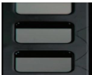
FIGURA 1 - DIFETTO DI STAMPAGGIO DOVUTO ALLA CONGIUNZIONE DI DUE FLUSSI INTORNO A UN'ASOLA IN UN PEZZO STAMPATO
