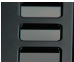
FIGURA 4 - SOLUZIONE DI STAMPAGGIO CON LA TECNOLOGIA DI RAFFREDDAMENTO PULSATO DELLO STAMPO EVITANDO LA LINEA DI GIUNZIONE DEI FLUSSI
