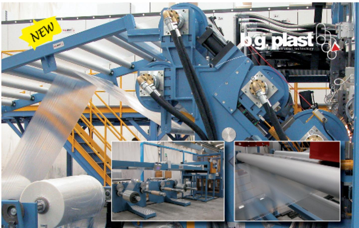
Linea di coestruzione PET (A-B-A) da 1500 kg/ora a partire da 100% flakes di bottiglia senza essiccatore !!
