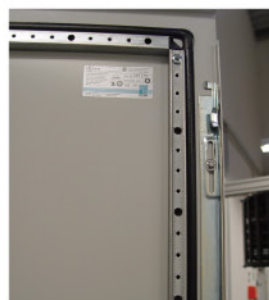
快乾Fermapor K31泡沫密封一般与粉末涂料喷涂控制柜附著性能良好，在不锈钢壳体上采用增粘底漆后可达到较好的附著性能
