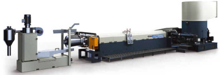
生产线的末端配备有TDA 6.0造粒机。GM210 Compac 的产能可保证达到2800 kg/h，功率消耗为 0.25-0.30 kw/kg
