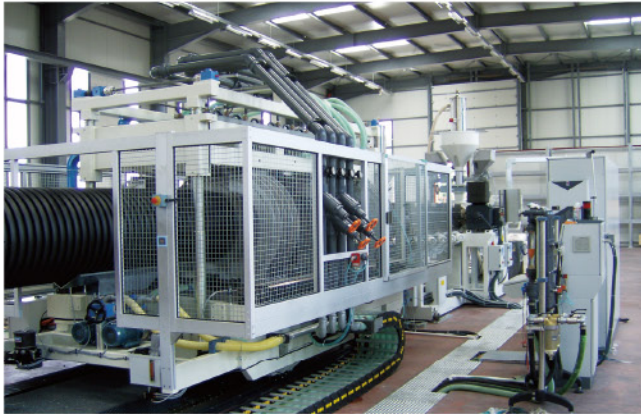
Itib Machinery公司开发的采用梭式技术的波纹管成型机
