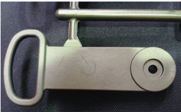
图1 - 注塑件上的圆形痕迹
