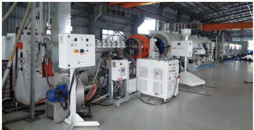
配备有管材气冷系统的1200mm生产线
