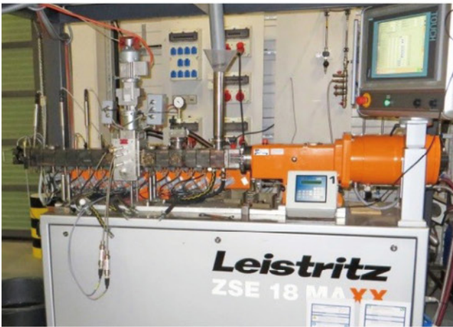
InnoREX项目 - Leistriz双螺杆挤出生产线实现在线控制粘度的连续聚合
