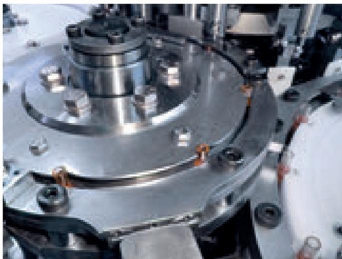
La cella per l'assemblaggio di due componenti utilizzati in ambito ospedaliero sviluppata da Gefit raggiunge una produzione oraria nominale fino a 22 mila pezzi grazie a una tavola rotante con tecnologia in continuo
