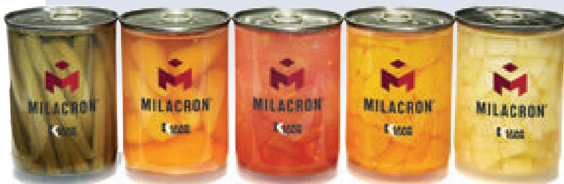
L'innovativa lattina trasparente Klear Can viene stampata mediante coiniezione di PP ed EVOH. Non contiene BPA, per un contatto sicuro con gli alimenti, ed è concepita per resistere alle pressioni e alle temperature standard (fino a 130°C) utilizzate per la sterilizzazione
