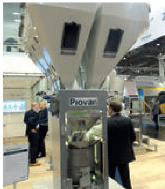
Il nuovo dosatore gravimetrico Quantum E è in grado di adattarsi automaticamente a repentini cambi di processo in virtù dei suoi mixer con OPC-UA posti sulle celle di carico
