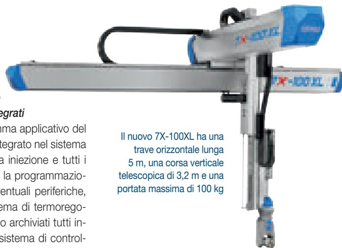
Il nuovo 7X-100XL ha una trave orizzontale lunga 5 m, una corsa verticale telescopica di 3,2 m e una portata massima di 100 kg
