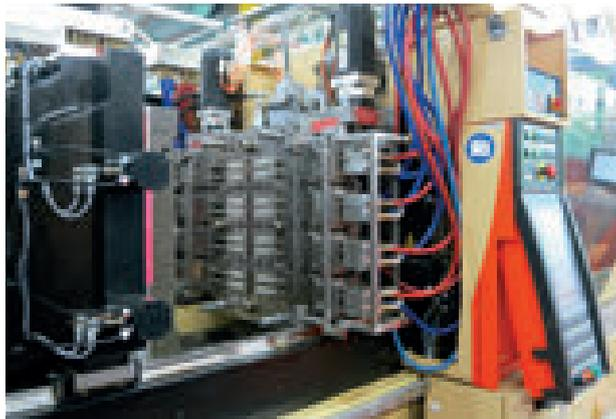
Blum sfrutta i vantaggi offerti dalla tecnologia senza colonne per costruire i suoi stampi. I motori per realizzare le filettature sporgono lateralmente oltre la superficie del piano portastampo. Nessun problema neppure per il cambio stampi. Grazie alla tecnologia senza colonne, è possibile montare lo stampo a 16 impronte su una pressa da 200 tonnellate
