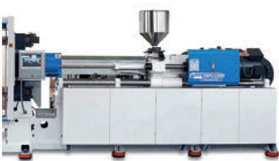
**Nell'unità di iniezione della serie eKW Full Electric due motori sincroni, accoppiati direttamente senza alcun dispositivo di trasmissione intermedio, comandano rispettivamente il movimento di iniezione e la rotazione della vite: in questo modo non si ha alcuna perdita di potenza e si riduce l'usura**
