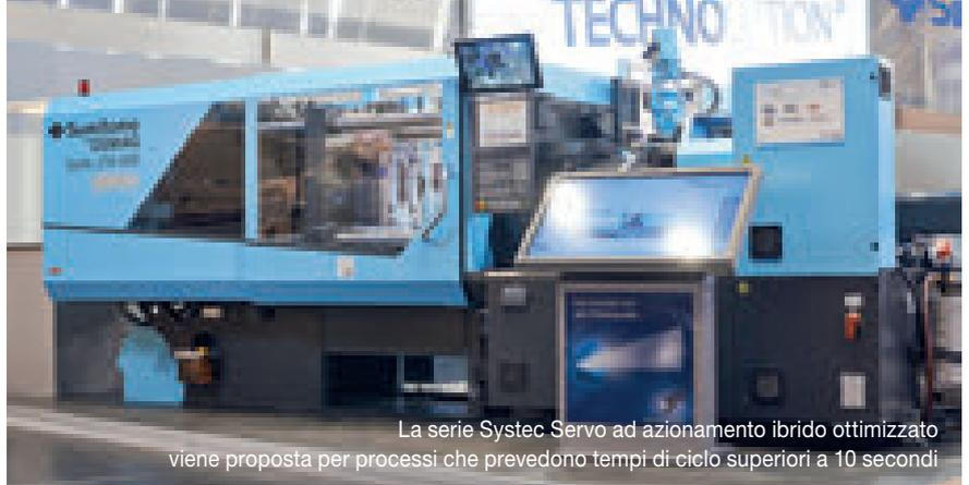
La serie Systec Servo ad azionamento ibrido ottimizzato viene proposta per processi che prevedono tempi di ciclo superiori a 10 secondi
