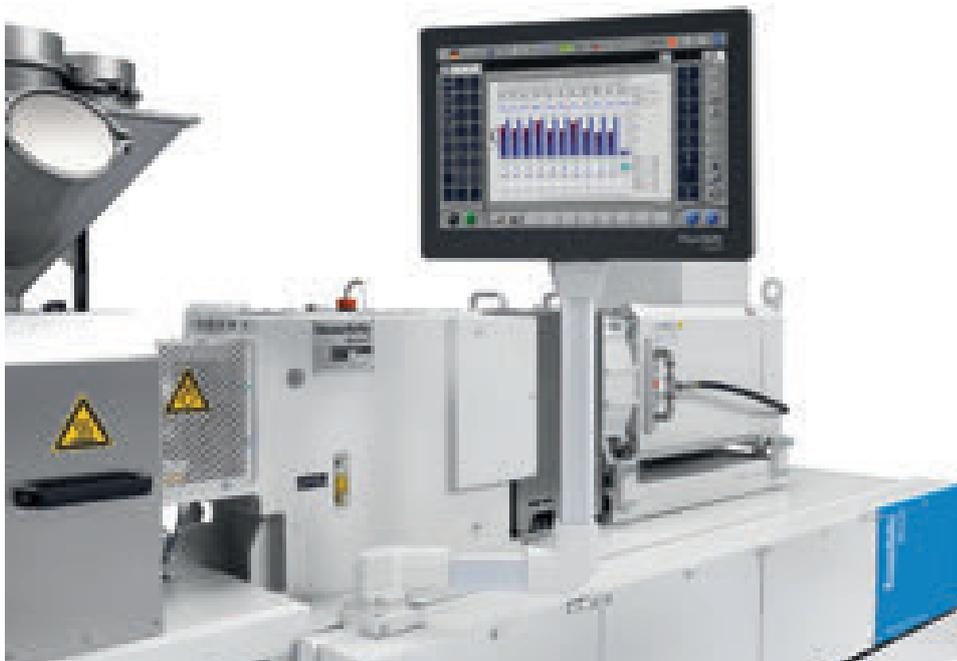
Il sistema di controllo BPCTouch viene lanciato al K 2016, a supporto del concetto generale Plastics 4.0. In futuro tutti gli estrusori bivate ZE BluePower, ZE UTX e ZE Basic saranno equipaggiati con questo nuovo dispositivo, in grado di migliorare la semplicità d'uso delle linee e ridurre i tempi di settaggio durante i cambi di produzione
