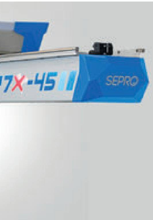
(gamma 5X e 7X), che ora include 6 modelli per automatizzare presse per stampaggio a iniezione da 20 a 5000 tonnellate.
