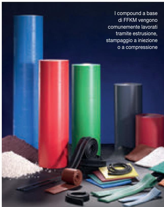
I compound a base di FFKM vengono comunemente lavorati tramite estrusione, stampaggio a iniezione o a compressione
