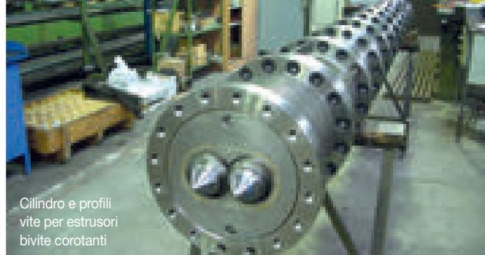
Cilindro e profili vite per estrusori bivate corotanti
