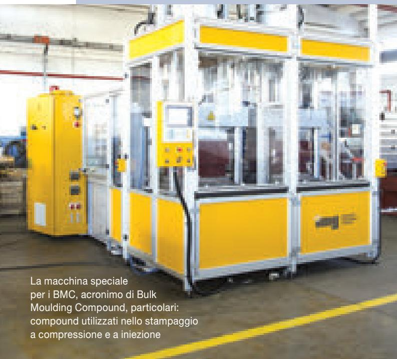
La macchina speciale per i BMC, acronimo di Bulk Moulding Compound, particolari: compound utilizzati nello stampaggio a compressione e a iniezione
