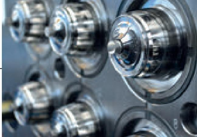
Dettaglio dello stampo utilizzato nel processo completo integrato messo a punto da Gefit per la produzione di capsule per caffè
