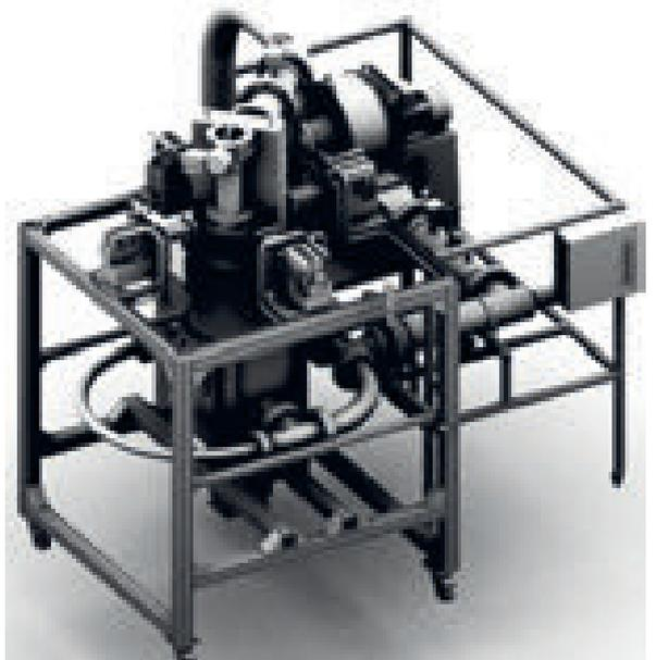
Rendering del prototipo di essiccatore messo a punto grazie al progetto europeo HiPerDry. Il sistema è concepito per l'essiccazione rapida ed efficiente dei materiali plastici convenzionali e delle bioplastiche
