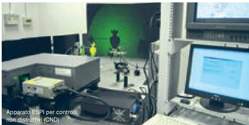
Apparato ESPI per controlli non distruttivi (CND)
