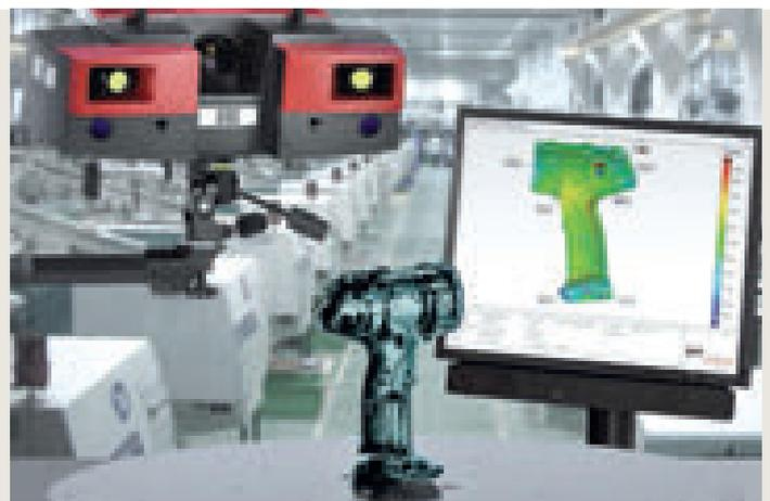
A differenza dei tradizionali sistemi di misura a coordinate e dei bracci di misura, il digitalizzatore Atos 3D acquisisce la geometria completa della superficie in una densa nuvola di punti
