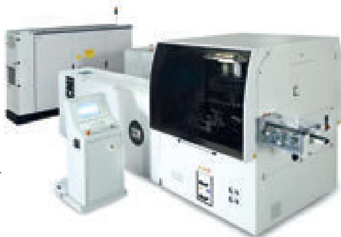
Pressa della gamma CCM per la produzione di tappi mediante tecnologia a compressione
