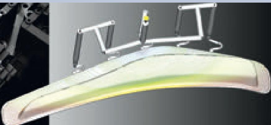
Servo azionamento del sistema FlexFlow per la regolazione precisa della valvola di un ugello a canali caldi (a sinistra nella foto), realizzato per uno stampo sequenziale con 5 punti di iniezione per la produzione di lenti di grande formato in PC cristallino per fanali automobilistici (a destra nella foto)
