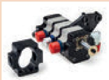
Il 21 giugno 2016 Solvay ha confermato che il suo poliarileterchetone (PAEK) AvaSpire AV-651 CF30 andrà a formare tre sezioni della carcassa esterna della pompa dell'olio di Polimotor 2, il primo motore realizzato interamente in plastica
