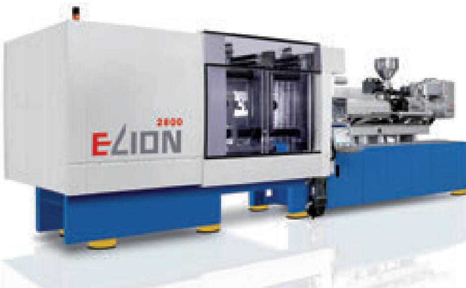
Al K 2016 Netstal da dimostrazione della tecnologia ICM (Injection Compression Moulding) mediante la produzione di un contenitore in PP da 425 g per margarina. Il contenitore pesa 10,7 g ed è realizzato con uno stampo a 4+4 cavità in un tempo di ciclo di 5 secondi, su una pressa Elion 2800-2000
