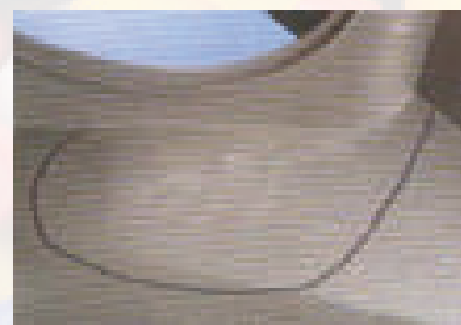
Fig. 1 - Inglobamento d'aria per effetto di flussi di fuso confluenti in un pezzo di polipropilene
