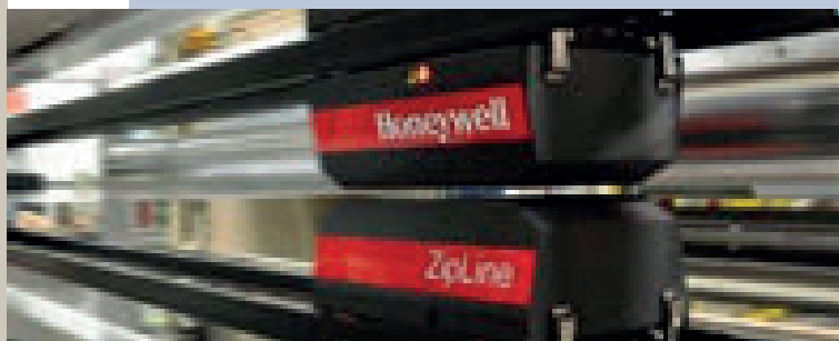
Il nuovo sistema di misura in scansione è dotato di teste che scorrono su cavi in acciaio tesi tra le spalle della macchina
