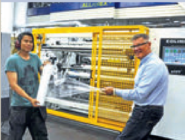
L'impianto ALLrollEX-1500 a testa piana, completamente automatico, è stato installato presso la società Doxa Plast per la produzione di film estensibile a 5 strati
