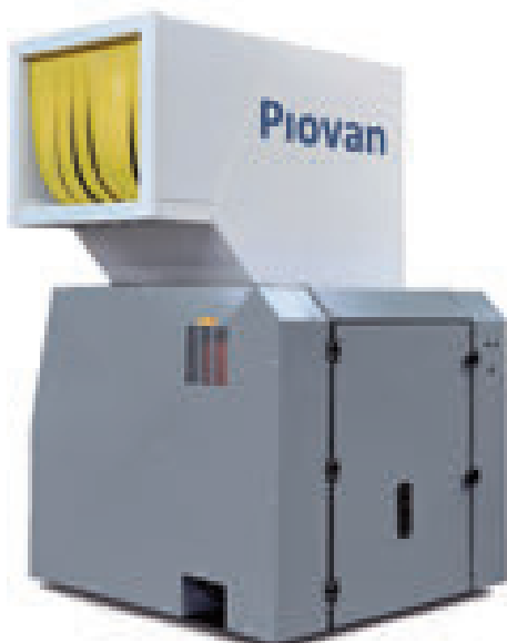
Il granulatore N35-60 è stato progettato principalmente per il riciclo di pezzi voluminosi stampati a iniezione o soffiati
