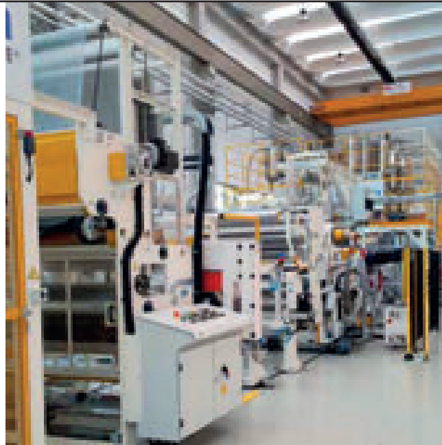
La linea Demo Line per la produzione di film rigido o espanso in PET, una delle due in funzione in occasione della lunga open house
