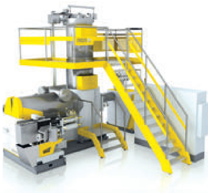
Rendering di un impianto P:React basato sui principi progettuali della Liquid State Polycondensation
