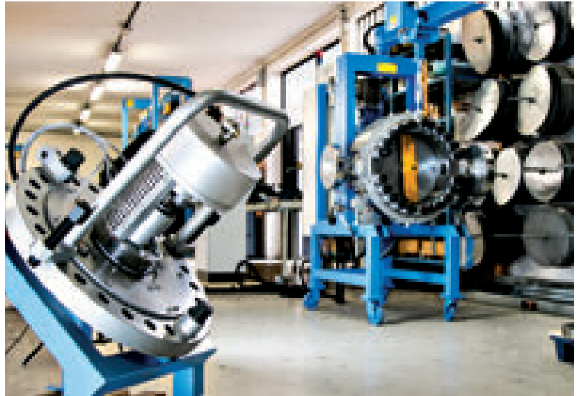
Grazie ai filtri forati al laser da 100 e 200 micron si ottengono filtrazioni fini che permettono di riciclare anche i materiali più contaminati
