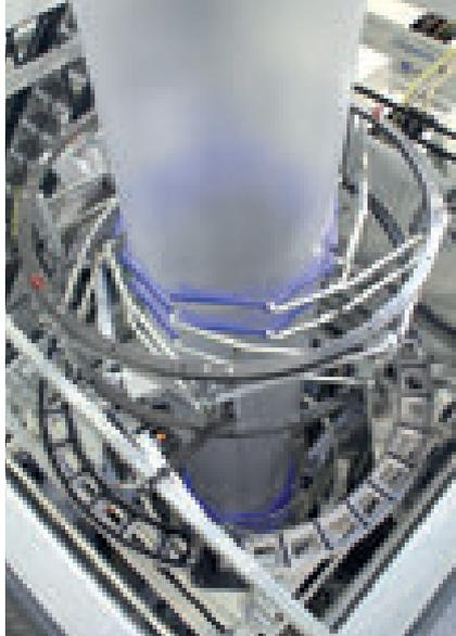
All'uscita della sezione con anello di raffreddamento, IBC, dispositivo di rilevamento dello spessore e gabbie di calibrazione, il film in bolla si dirige verso l'alto dell'impianto, dove sono installati sistema di appiattimento e traino
