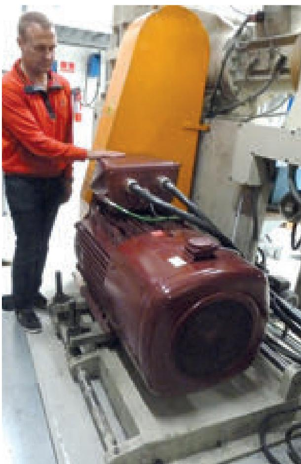
Anziché ricondizionare o sostituire i motori usurati dei propri estrusori, soluzione che avrebbe comportato un notevole impiego di tempo e denaro, in quanto avrebbero dovuto essere realizzati su commessa, il trasformatore ha preferito rimpiazzarli con motori a magneti permanenti a elevata efficienza
