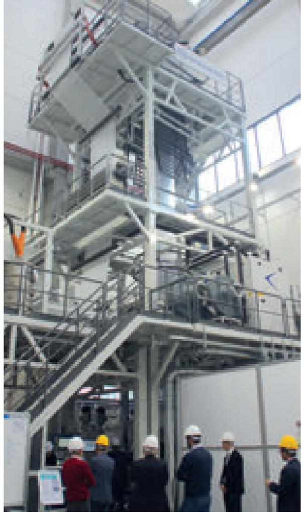
L'impianto BarrierFlex per la produzione di film barriera a 7 strati raggiunge un'altezza complessiva di quasi 16 metri: un vero e proprio gigante nel suo genere, come si rileva dal raffronto con l'altezza degli ospiti dell'open house del 6 e 7 ottobre
