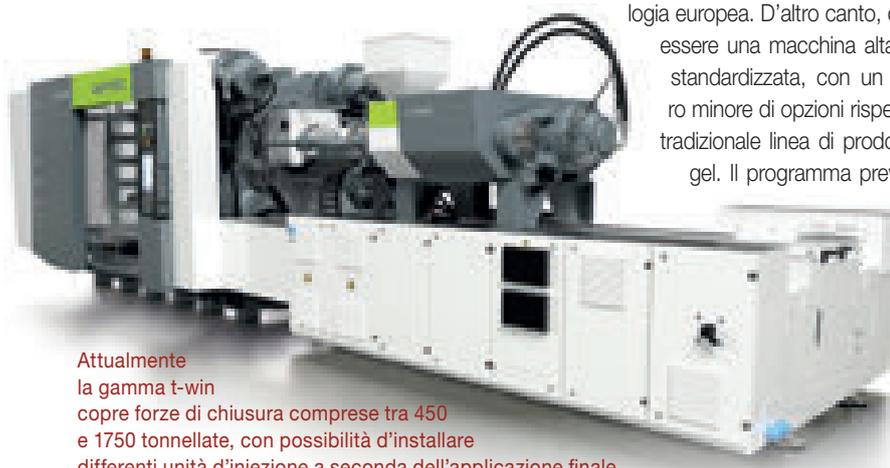
Attualmente la gamma t-win copre forze di chiusura comprese tra 450 e 1750 tonnellate, con possibilità d'installare differenti unità d'iniezione a seconda dell'applicazione finale
