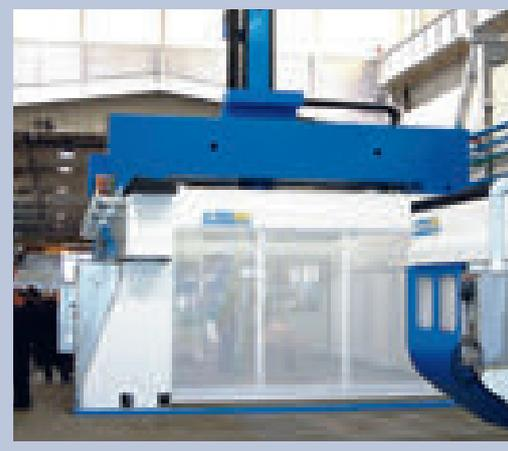
Sebbene il modello in esposizione fosse dotato di una semplice testa a 3 assi, i centri di lavoro LaborMax sono tra i più versatili della gamma e sono configurabili anche a 5 assi, ideali per la fresatura di materiali plastici, compositi, alluminio e leghe leggere
