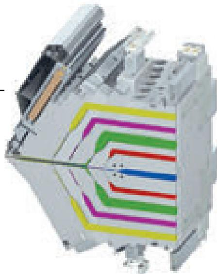
Vista in sezione di una testa di estrusione Nordson EDI a 9 canali, con i flussi di polimero rappresentati con colori diversi. I flussi vengono combinati a formare un'unica struttura multistrato che esce dalla testa sulla sinistra. Nell'estremità superiore sinistra si osserva un'unità Autoflex per la regolazione automatica del labbro d'uscita
