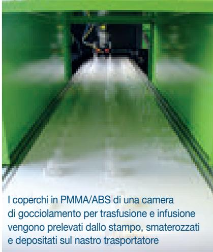
I coperchi in PMMA/ABS di una camera di gocciolamento per trasfusione e infusione vengono prelevati dallo stampo, smaterozzati e depositati sul nastro trasportatore
