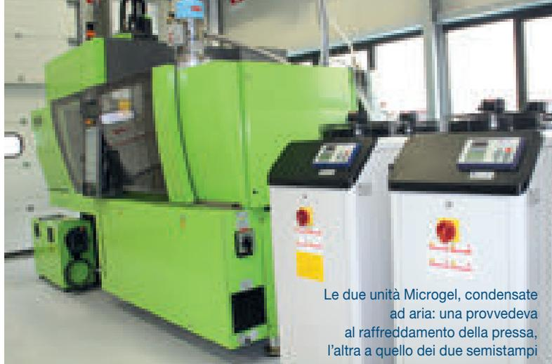
Le due unità Microgel, condensate ad aria: una provvedeva al raffreddamento della pressa, l'altra a quello dei due semistampi
