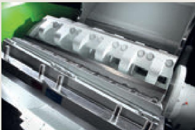
Dettaglio del nuovo granulatore Panther messo a punto da Pallmann per il riciclo di bottiglie in PET post consumo
