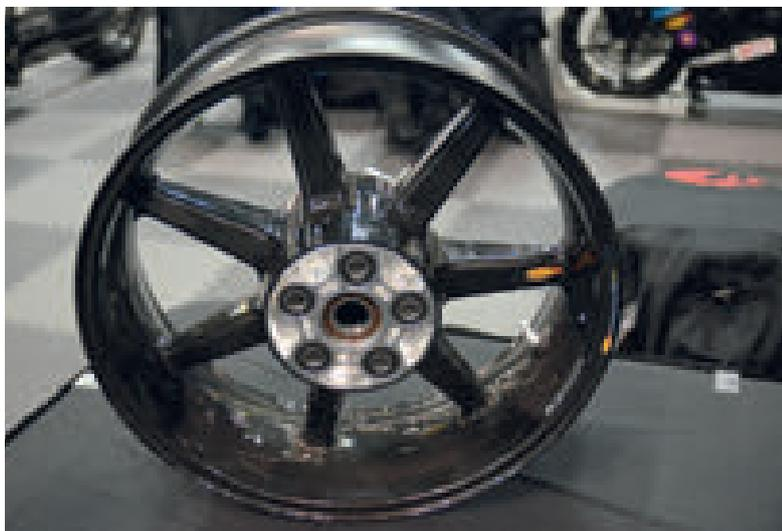
A parte questi importantissimi miglioramenti sono stati fatti altri progressi nella fabbricazione, compreso lo sviluppo di un processo di polimerizzazione fuori autoclave per i materiali preimpregnati impiegati per fabbricare la ruota. Il processo include la polimerizzazione in forno della ruota utilizzando un dispositivo a pressione interna ed esterna appositamente costruito, che può essere rimosso e riutilizzato per altre ruote.
