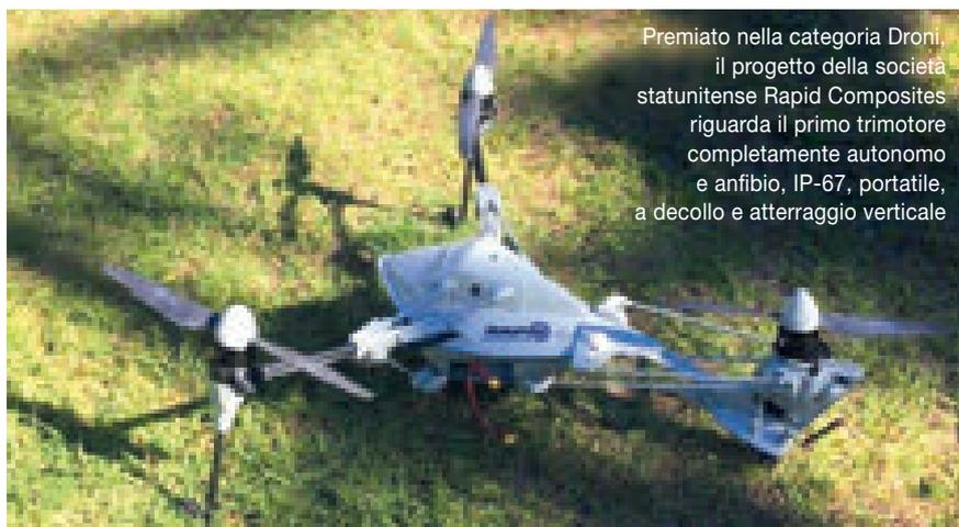
Premiato nella categoria Droni, il progetto della società statunitense Rapid Composites riguarda il primo trimotore completamente autonomo e anfibo, IP-67, portatile, a decollo e atterraggio verticale
