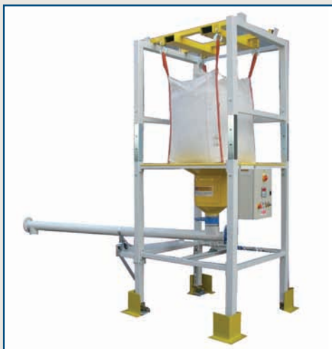
Установка опорожнения биг-бегов, снабженная системой взвешивания с учетом веса тары и ориентируемым дозирующим шнеком
