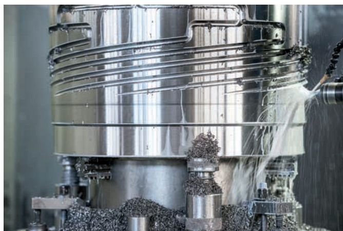
Одна из производственных фаз работы головки для изготовления выдувной пленки
