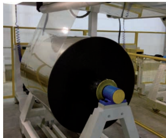
В конце линии установлен узел замотки, состоящий из двух постов с каретками под рулоны диаметром до 1500 мм
