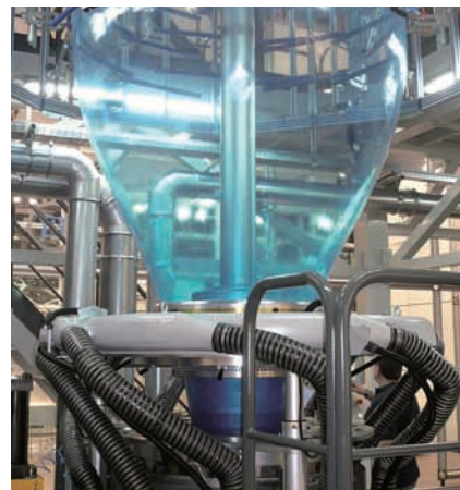
Детальный вид установки для производства пузырчатой пленки с трехпоточным кольцом охлаждения
