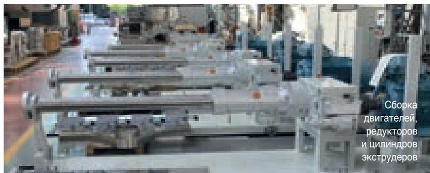
Сборка двигателей, редукторов и цилиндров экструдеров
