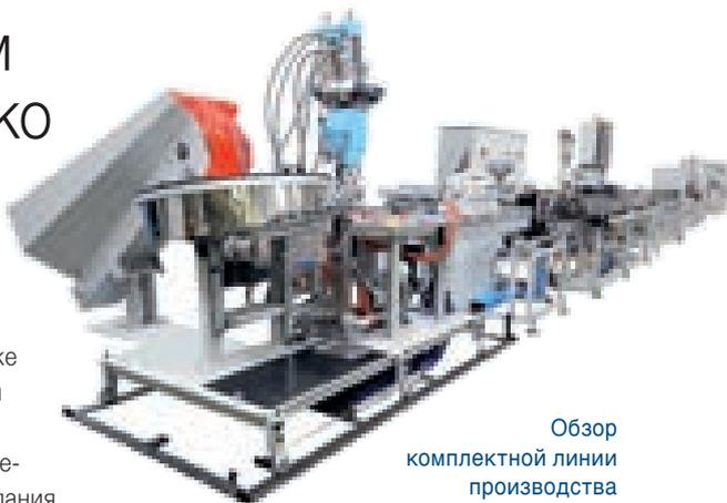
Обзор комплектной линии производства Profile Dies - от подачи сырья до экструзии
