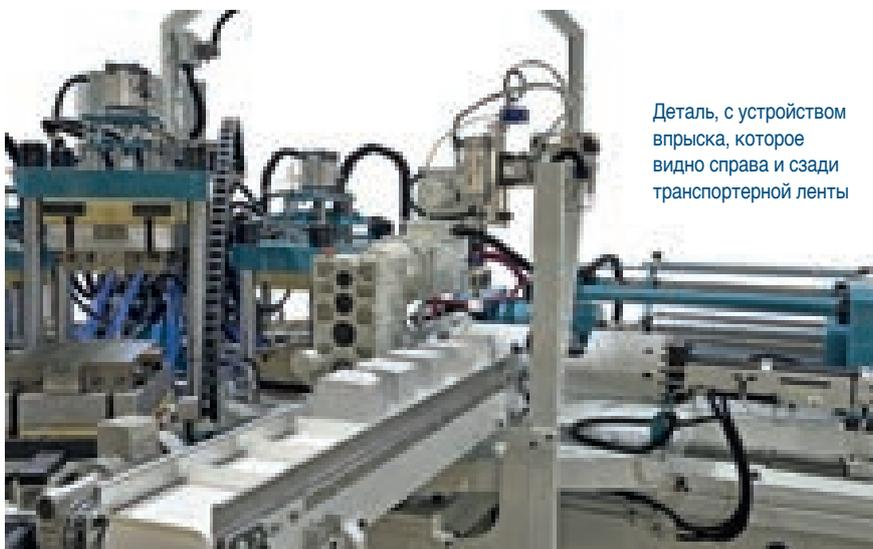
Деталь, с устройством впрыска, которое видно справа и сзади транспортной ленты
