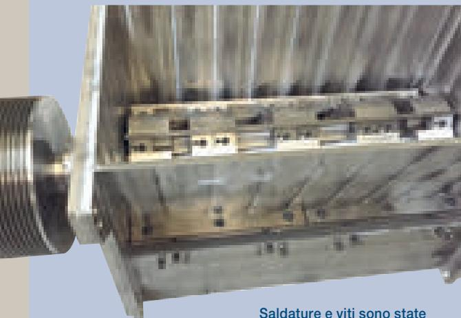
Saldature e viti sono state sostituite rispettivamente da spine e bulloni e da tasselli conici, per ottenere le prestazioni necessarie a trattare bottiglie in PET post consumo garantendo resistenza e solidità
