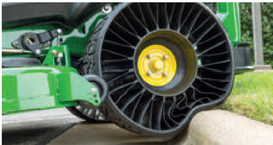
Utilizzato soprattutto per piccoli veicoli agricoli, il nuovo pneumatico X Tweel di Michelin è costituito da un mozzo rigido centrale collegato a una sorta di battistrada esterna mediante raggi flessibili in poliuretano
