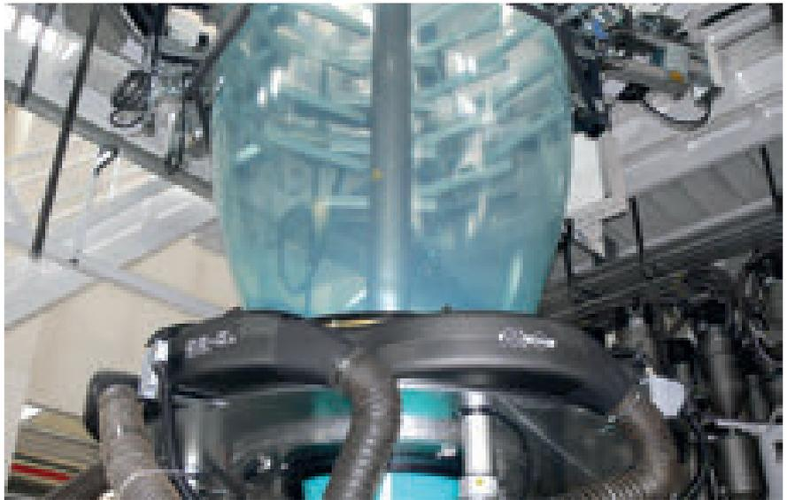
Un dettaglio della bolla del film a 5 strati. Quello prodotto da Macchi a scopo dimostrativo durante il K 2016 era realizzato con una formula speciale, concepita appositamente da The Dow Chemical Company
