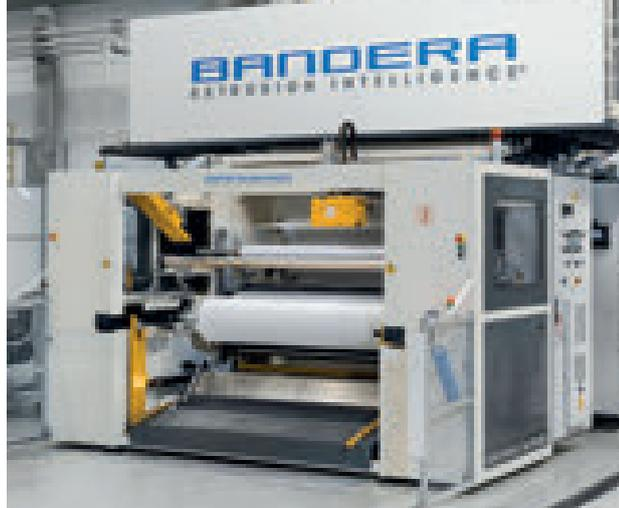
Avvolgitore e sistema di carico e scarico bobine di un impianto Bandera
