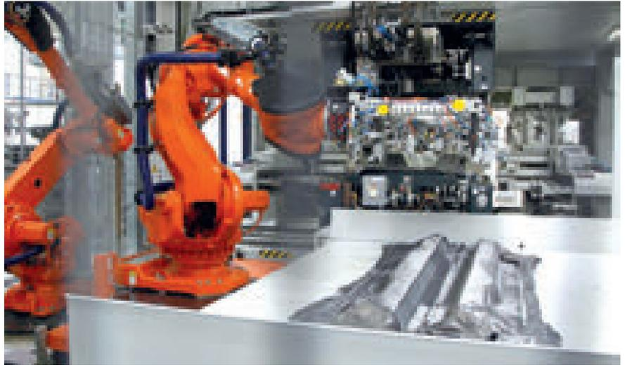
**Nell'impianto di BMW destinato al processo RTM ad alta pressione, il tempo di ciclo per alcuni grandi componenti in composito è stato ridotto da 30 a 10 minuti**
