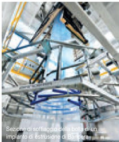
Sezione di soffiaggio della bolla di un impianto di estrusione di Bandera
