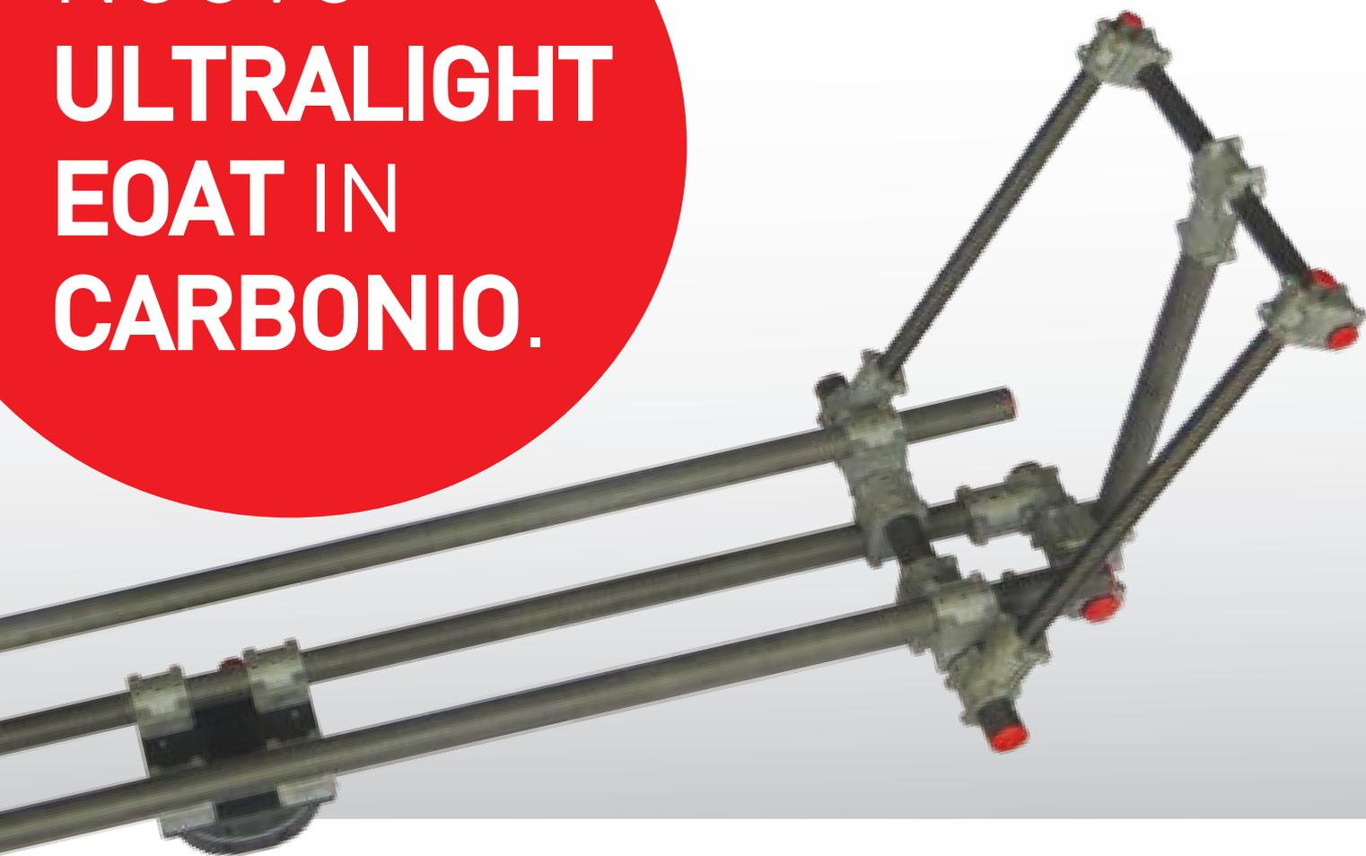
Oggi Gimatic, è l'azienda in grado di offrire la gamma più completa nel settore delle materie plastiche. Il nuovo Ultralight EOAT creato da Gimatic rappresenta un sistema di tubi e staffe adatti alla costruzione dei telai degli EOAT più comuni. Non solo componenti, ma sistemi tecnologicamente avanzati di strutture integrate, flessibili, compatibili, modulabili e con un ottimo rapporto qualità prezzo.
