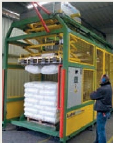
Il sistema automatico LaborSave per aprire e svuotare i sacchi di materie prime raggiunge un livello di efficienza del 99,99%
