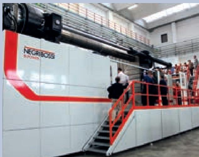
Il modello VH 7000 rappresenta la macchina più grande della gamma a due piani Bi-Power. Questa comprende altre otto versioni con forza di chiusura di 1000, 1300, 1500, 2000, 2500, 2700, 3500 e 5500 tonnellate, per assecondare il più ampio spettro possibile di applicazioni di grandi dimensioni.
