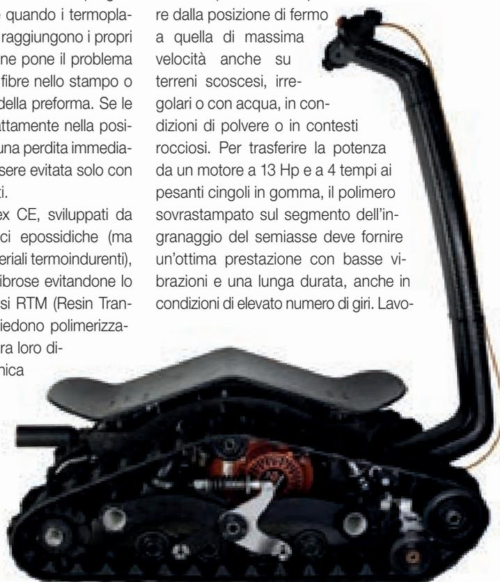
**Il veicolo Shredder, a doppio cingolo, si basa su un semiasse in acciaio sovrastampato con il polimero Victrex WG (foto: BPG Werks)**
