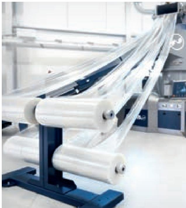
Tra le prove effettuate al "Discovery Day" di Erema rientrava il riciclo completamente automatico di rifili, per mezzo del sistema Intarema K
