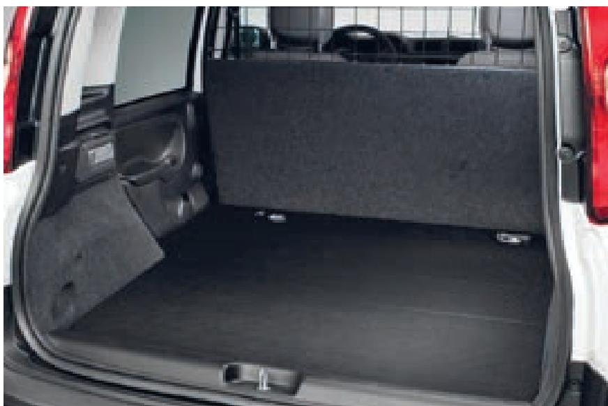
Il piano di carico della nuova Panda Van 139 è stato realizzato con lastre alveolari in polipropilene fornite da Imballaggi Protettivi (foto: co2motori.blogspot.it)
