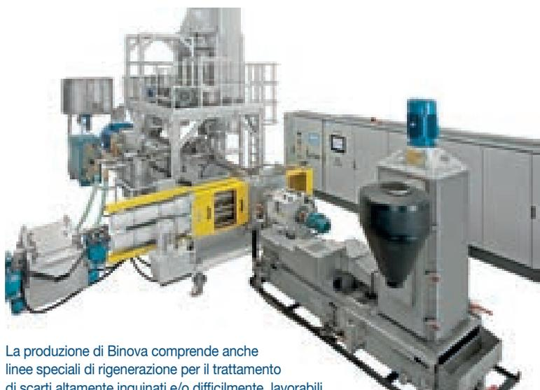
La produzione di Binova comprende anche linee speciali di rigenerazione per il trattamento di scarti altamente inquinati e/o difficilmente lavorabili
