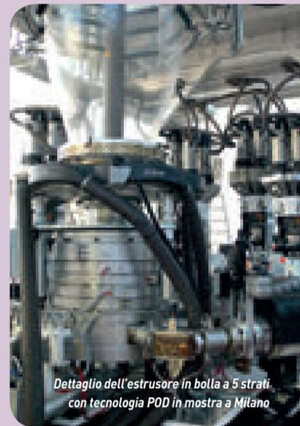
*Dettaglio dell'estrusore in bolla a 5 strati con tecnologia POD in mostra a Milano*
