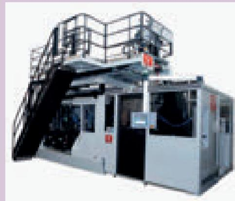
Il gruppo di soffiaggio della ISIT 400 è dotato di una struttura collegata al basamento principale attraverso pattini a ricircolo di rulli
