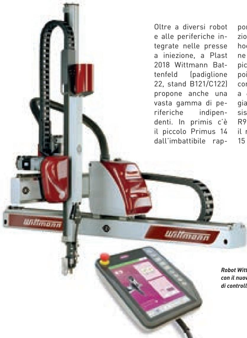
Robot Wittmann W918 con il nuovo sistema di controllo CNC9 pro
