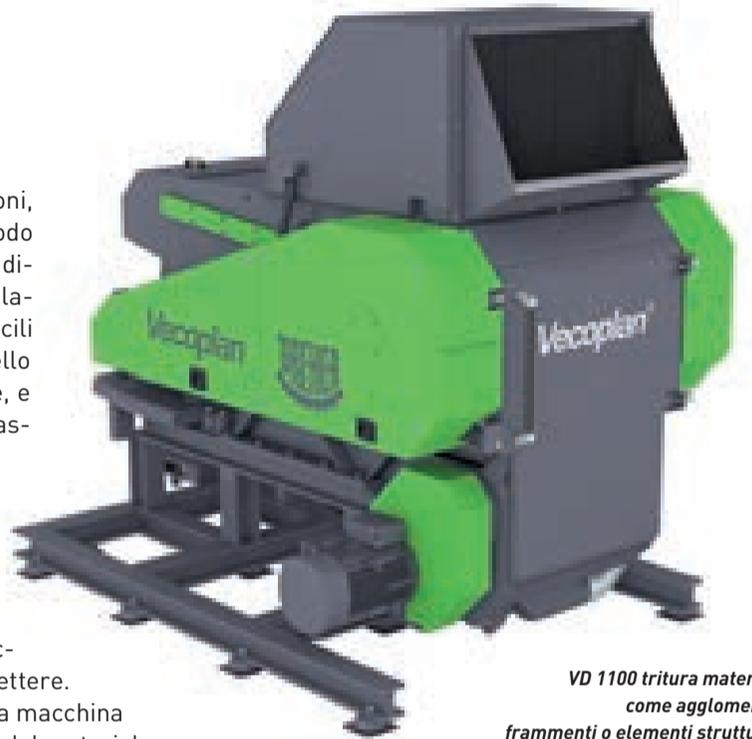
*VD 1100 tritura materiale come agglomerati, frammenti o elementi strutturali di grandi dimensioni in due fasi producendo granulato delle dimensioni desiderate.*
