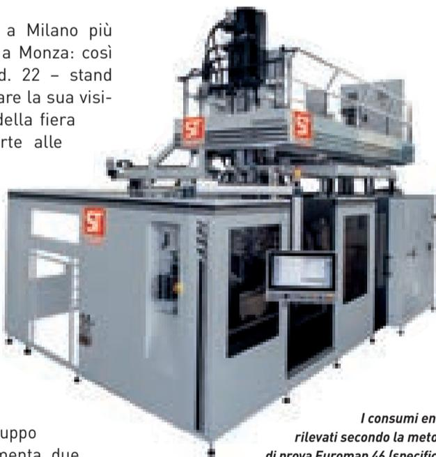
*I consumi energetici rilevati secondo la metodologia di prova Euromap 46 (specificamente dedicata alle macchine di estrusione soffiaggio) collocano molti modelli della serie Isit nella classe di merito più alta (consumo inferiore a 0,29 kWh per kg di HDPE lavorato)*
