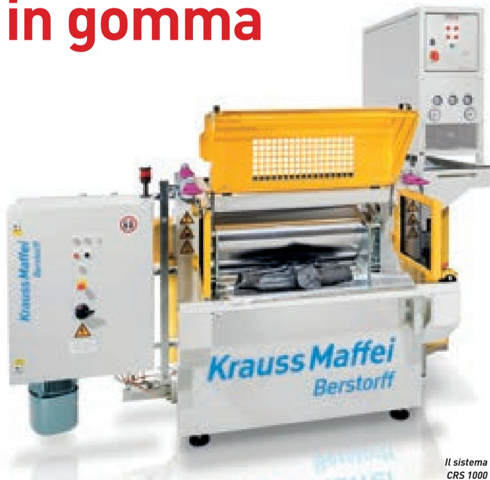
*Il sistema CRS 1000 di KraussMaffei Berstorff ha due cilindri riscaldati ed un dispositivo idraulico di aggiustamento della distanza*
