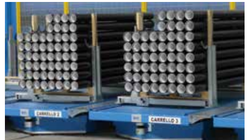
意大利制造商IPM还能生产自动包装设备，同时处理由4条挤出生产线生产的不同直径，最多6种长度的管材；每小时可以自动管理、包装多达3600个管材
