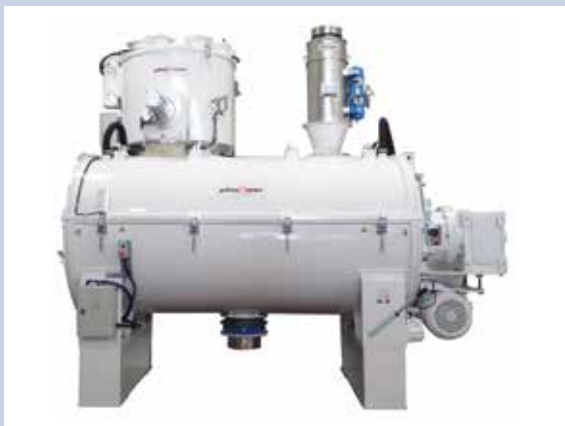
HC Combimix系统将TRM加热混料机与高性能HEC卧式冷却器结合为一体
