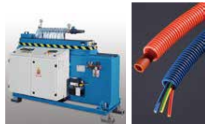
FMV15/70-110波纹管成型机主要用于制造汽车行业用管材
