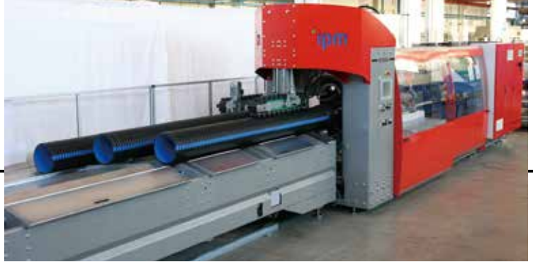
在BA 500 INJ生产线上进行波纹管扩口
