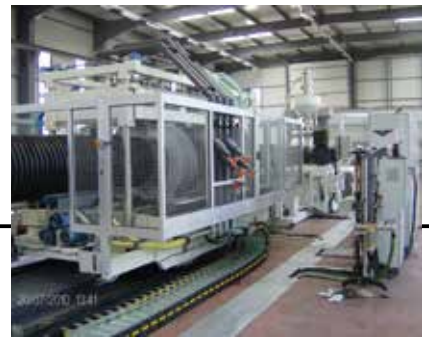
采用Itib Machinery International公司F700波纹管成型机的波纹管挤出生产线
